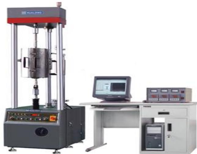
Figura N° 10 Máquina de ensayo de tracción controlado por ordenador / electromecánico
