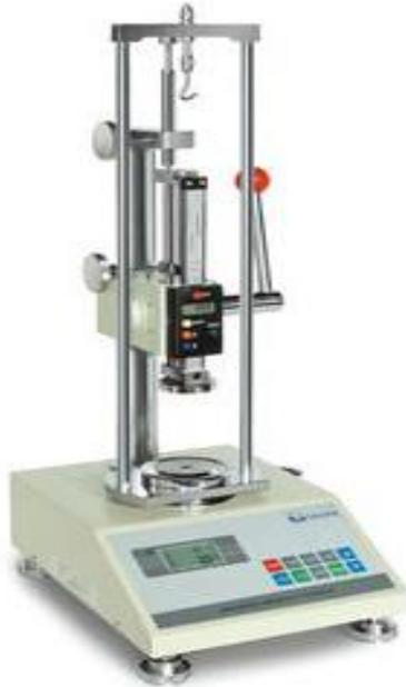
Figura N° 8 Máquina de ensayo de tracción manual
