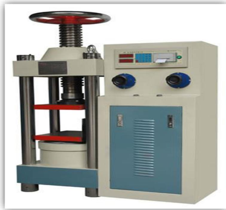
Figura N°9: máquina de ensayo de tracción universal por sistema mecánico
