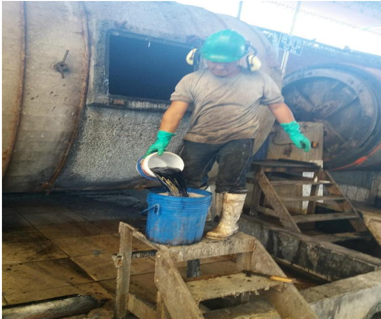
Figura 15: Extracción de agua residual del botal curtidor
