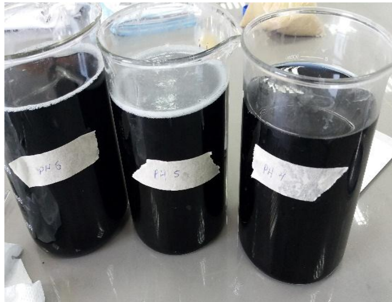
Figura 19: Regulación a pH 4, 5 y 6 con bicarbonato de sodio
