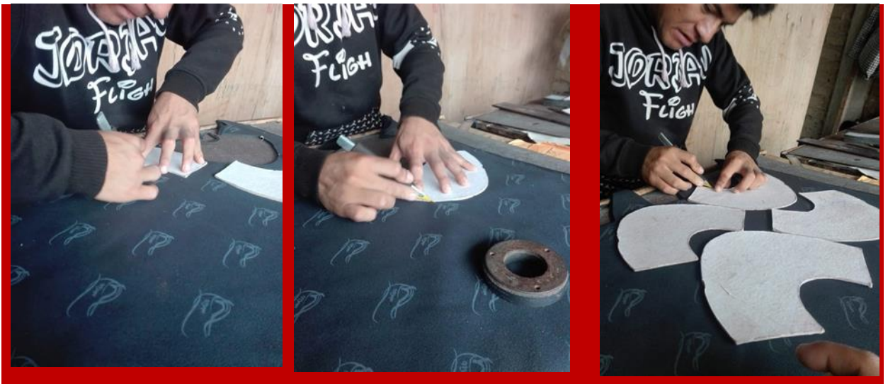
Figura 29: Cortado con moldes de cartón, antes de la implementación
