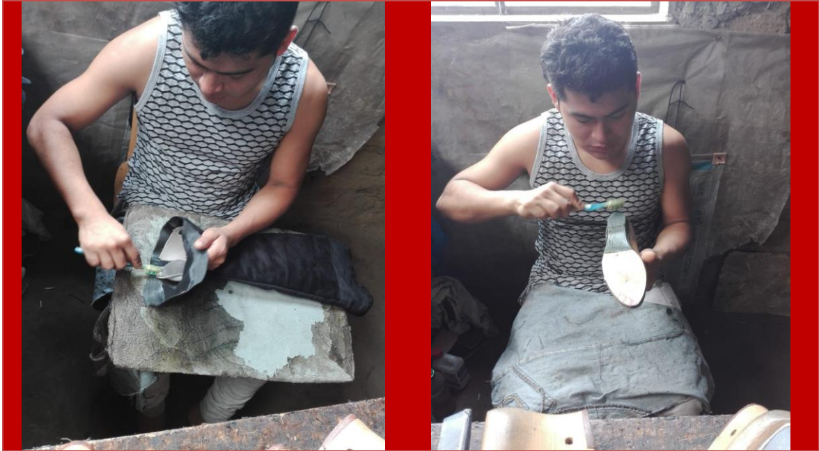
Figura 32: Untado de pegamento con el cepillo, después de la implementación del Poka Yoke
