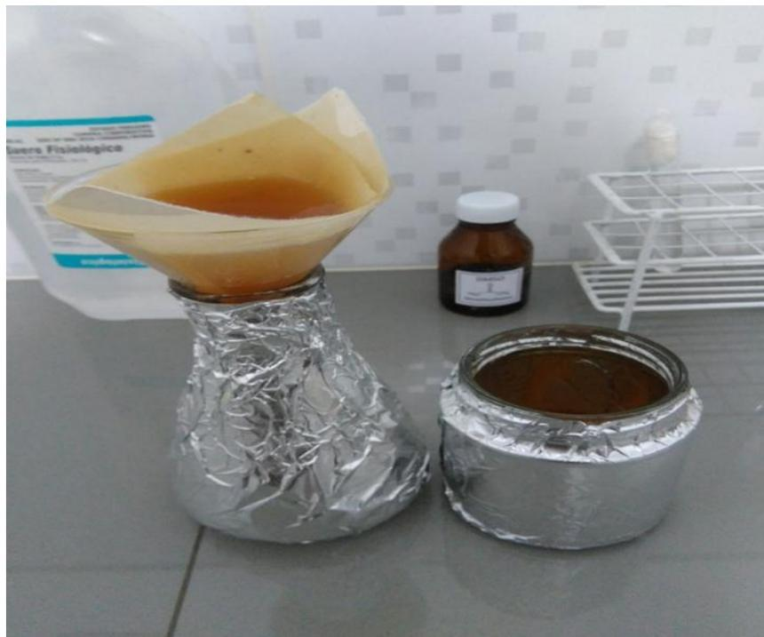
**Foto N° 04:** Procedimiento de filtración para la obtención del extracto etanólico
