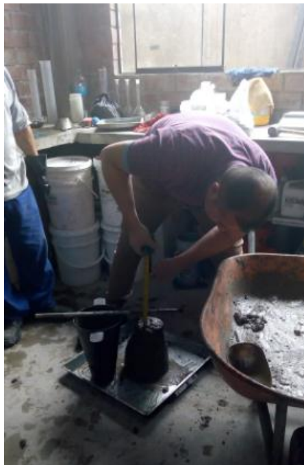
Figura 37. Determinando slump de la mezcla para concreto
