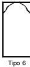
Figura 20. Falla por fractura tipo 6.
