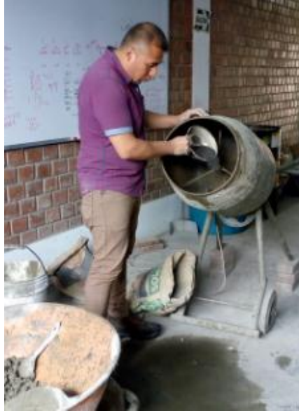
Figura 36. Echando desechos de alambros en el trompo con mezcla para concreto.
