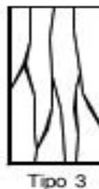
Figura 17. Falla por fractura tipo 3.
