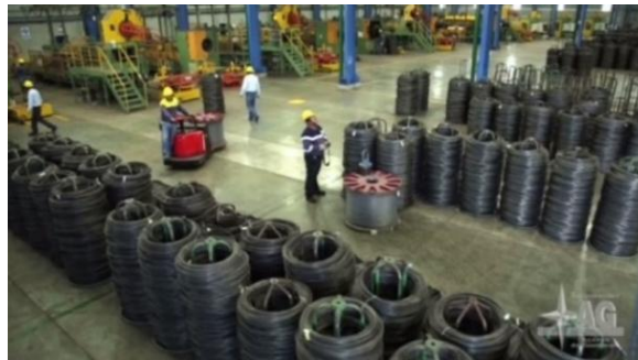
Figura 5. Fardos de alambión limpio y listo para pasar por proceso de trefilado.
