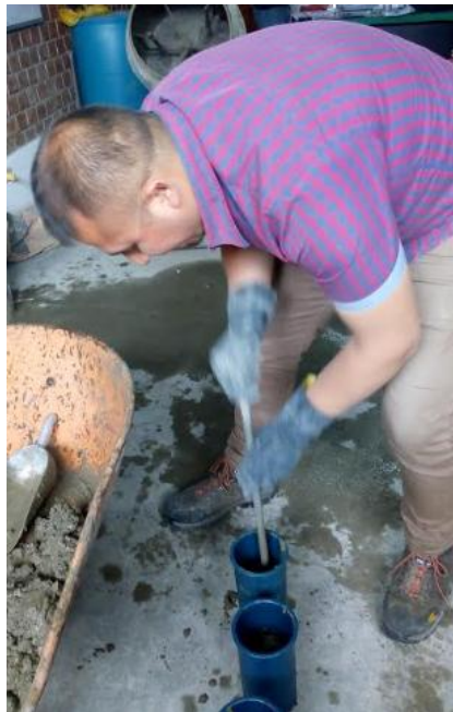
Figura 38. Aplicando los 25 golpes por cada capa.
