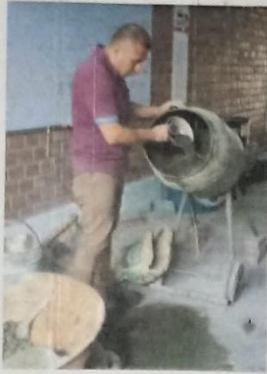
Figura 14. Echando desechos de alambros en el trompo con mezcla para concreto Fuente: Elaboración propia
