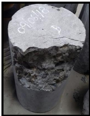
Concreto sin fibra
