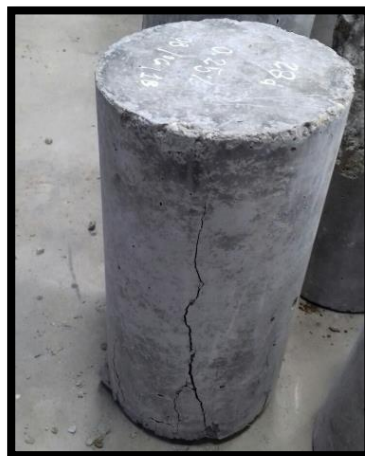
Concreto con fibra
