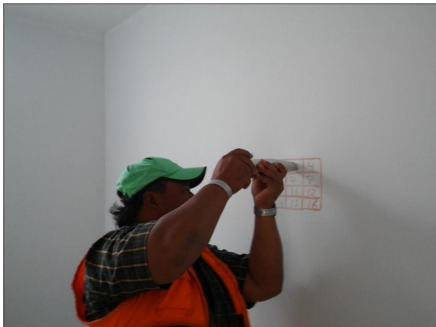
*Figura 56. Medición del valor de rebote*
