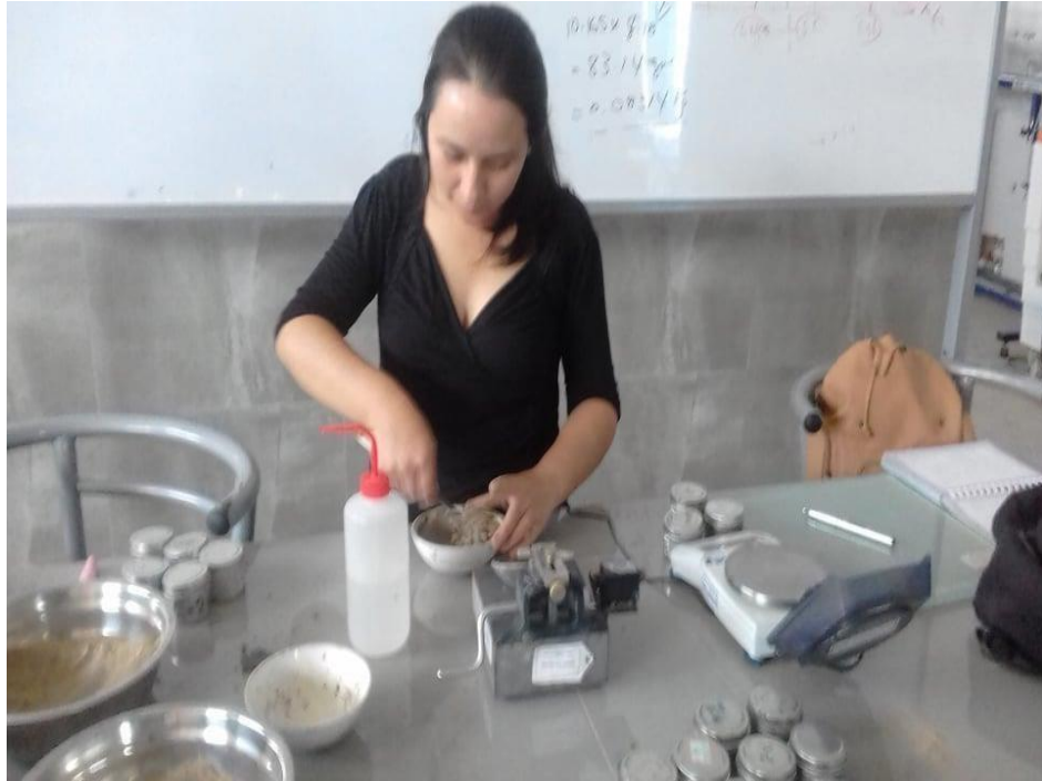
FIGURA N° 05: Procedimiento para el límite líquido
