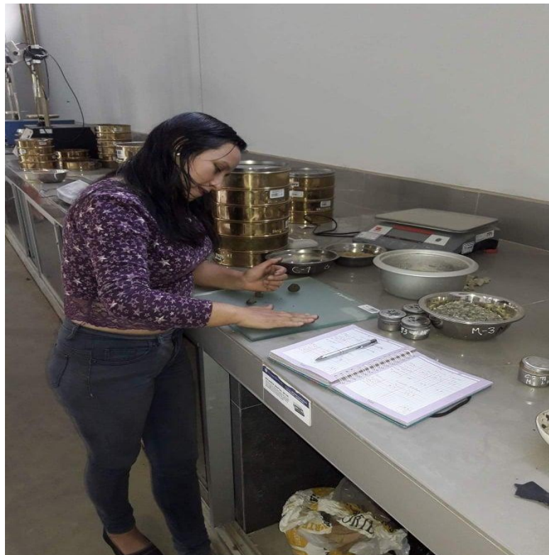
FIGURA N° 04: Procedimiento para el límite plástico
