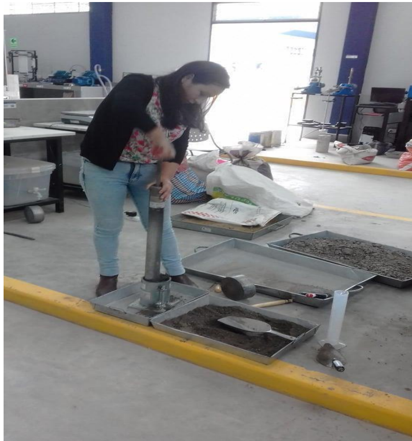
FIGURA N° 08: Procedimiento de compactación 25 golpes por 5 capas
