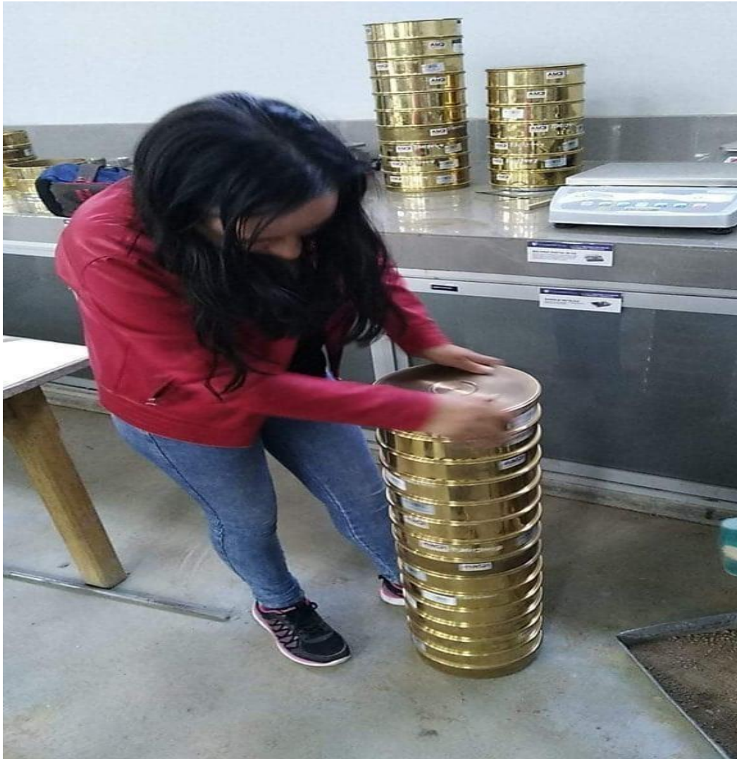
FIGURA N° 03: Tamizando la muestra del estudio de las diferentes calicatas. Fuente: Elaborado por el investigador
