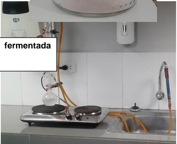
Figura 16. Extracción del principio activo mediante el equipo Soxhlet
