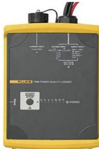
Figura N° 11: Analizador de calidad de potencia Fluke 1743
