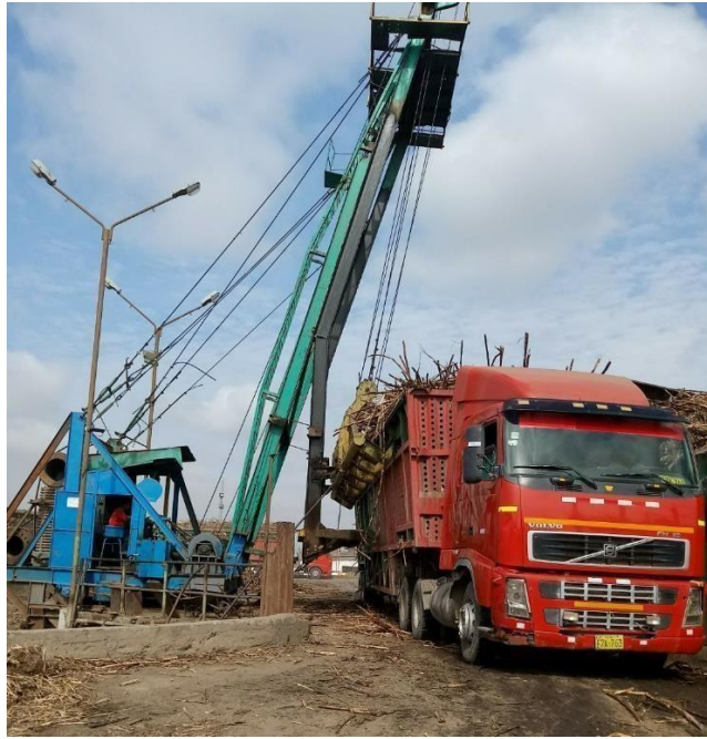
Vista Fotográfica de la Grúa Hilo en Pleno Trabajo de cargio
