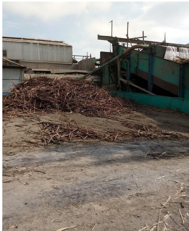
Vista Fotográfica de la Problemática de desperdicio de Caña de Azúcar en Mesa Alimentadora
