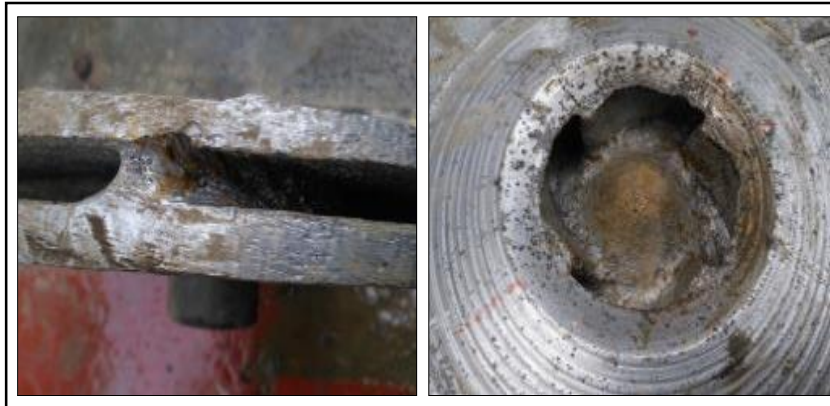
Ilustración 34. Impulsor con desgaste y cavitación
