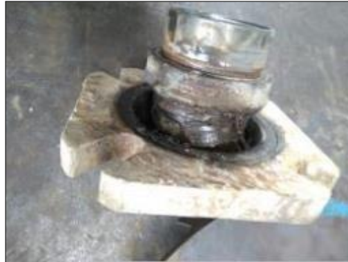
Ilustración 37. Desalineamiento de botella y eje
