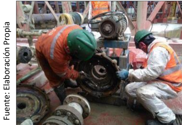
Ilustración 31. Análisis manual de Bomba Warman
