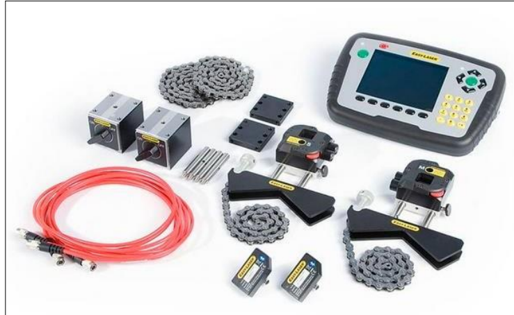
Ilustración 19. Easy Laser E720
