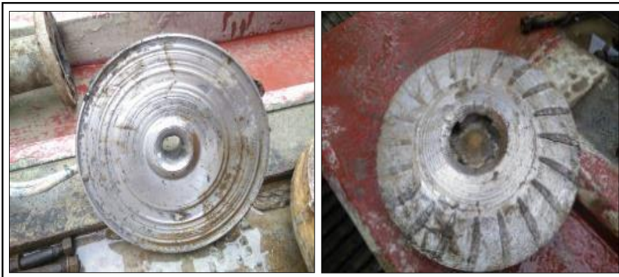
Ilustración 35. Desgaste de discos de succión
