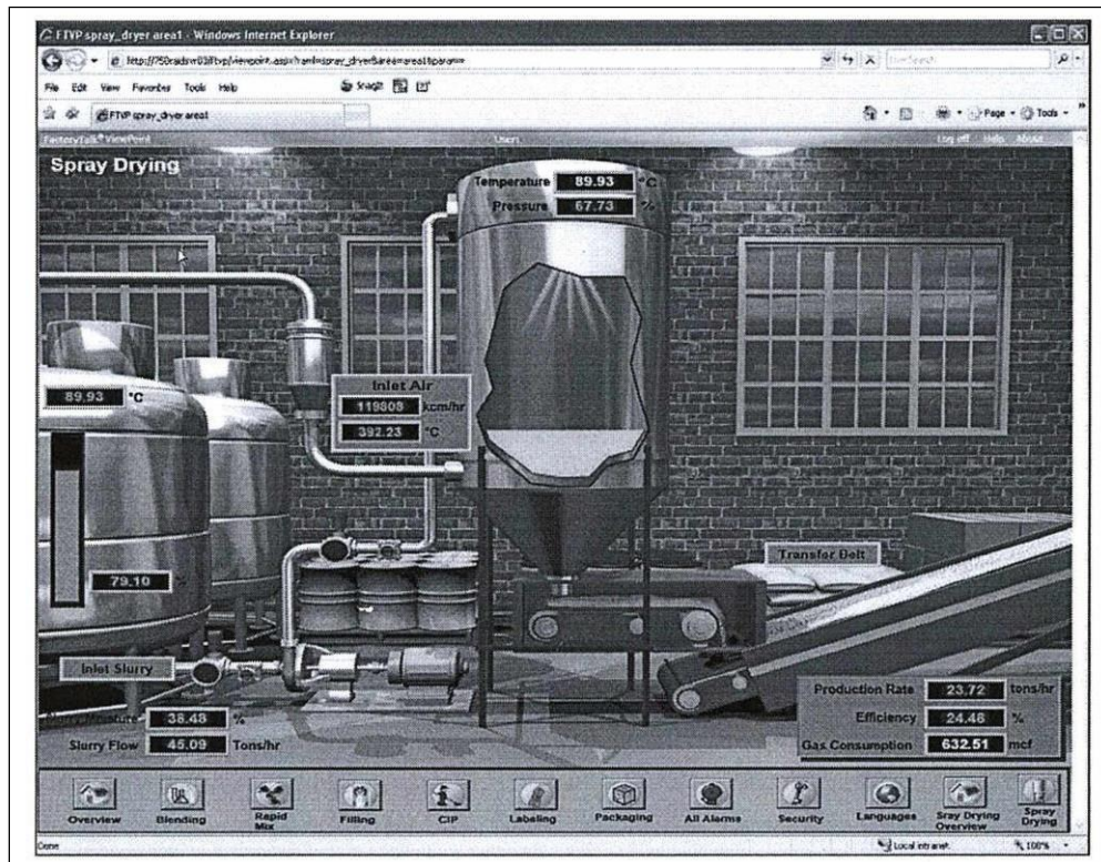
Figura 48. Sistema de supervisión FACTORY TALK
