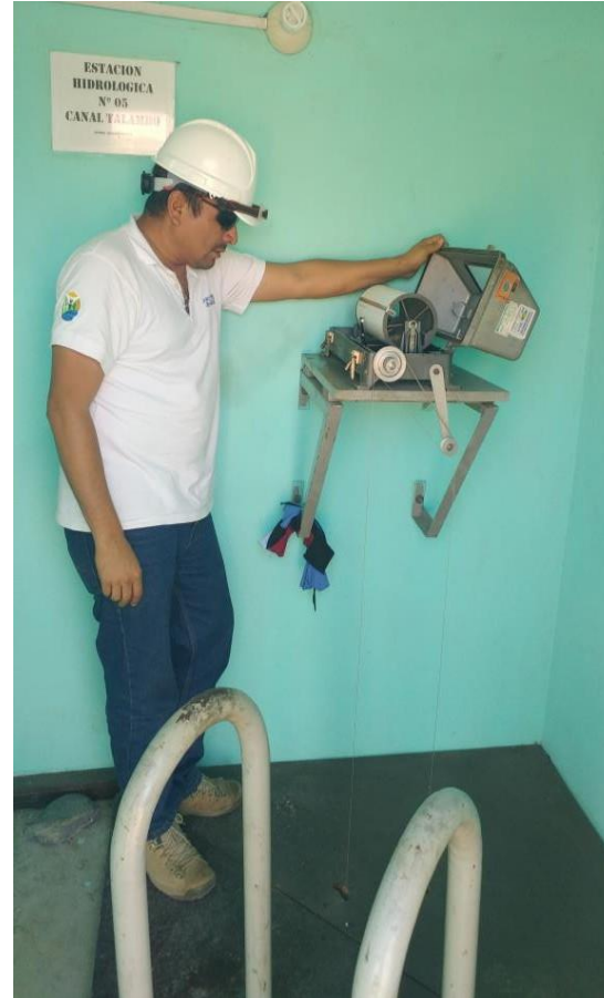
Figura 107. Lectura de limnógrafo.
