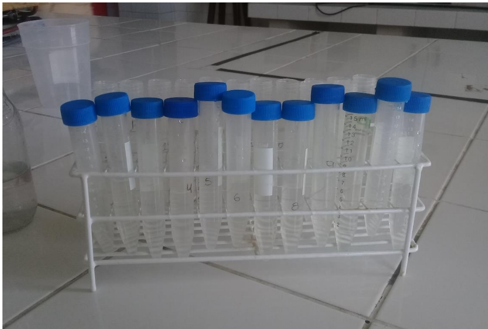
Figura 23: Aforar en tubo de ensayo hasta 7ml con agua destilada
