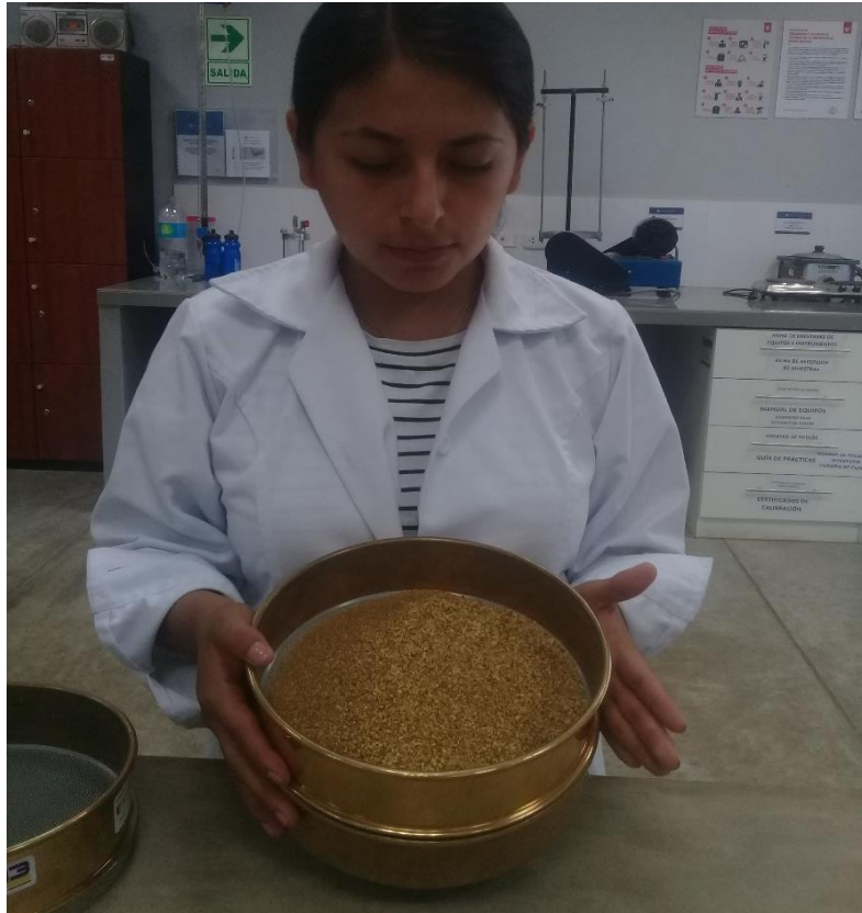
Figura 9: Tamizado de la cáscara usando diferentes mallas granulométricas
