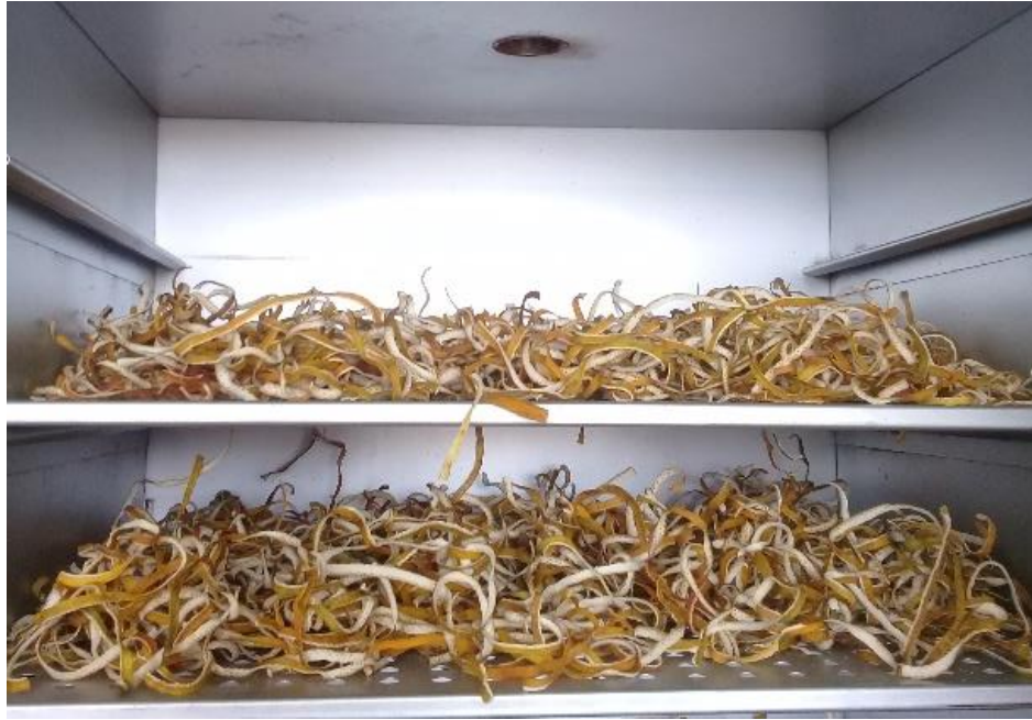
Figura 7: Secado de la cáscara de naranja en estufa a 60°C
