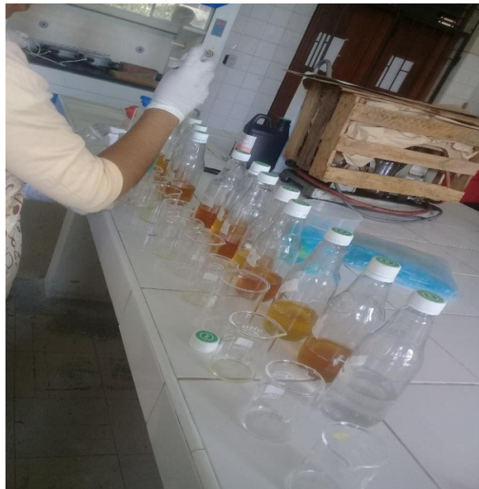
Figura 19: Adición de 6ml de ácido nítrico concentrado
