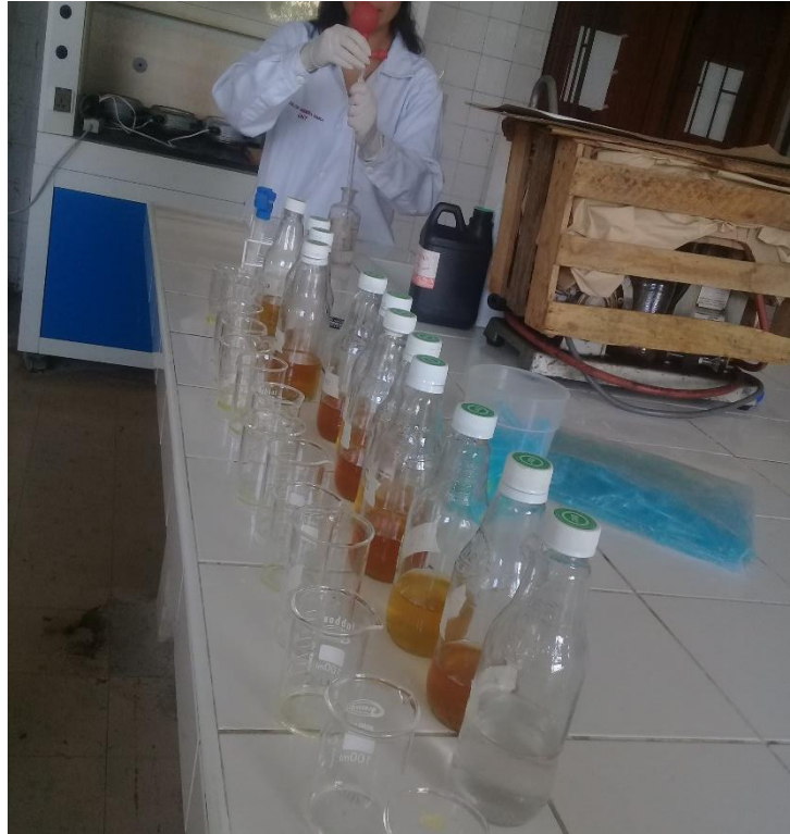
Figura 18: Adición de 400ml de peróxido de hidrogeno
