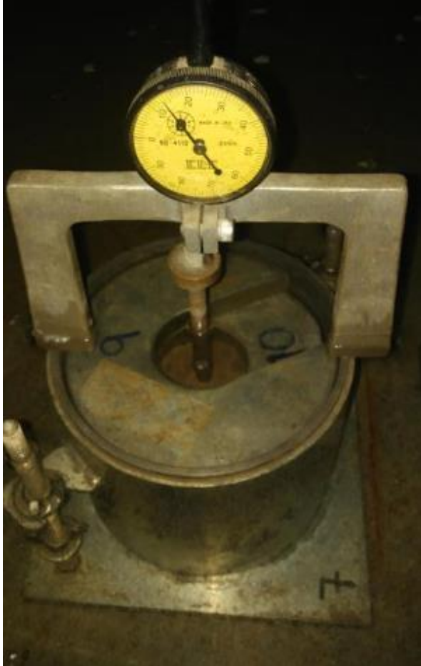
ENSAYO DE ESPONJAMIENTO – CBR
