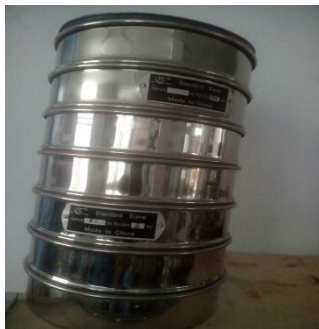
Figura 14 Juego de tamices Para Ensayo de Granulometría por tamizado de Calicatas del Proyecto
