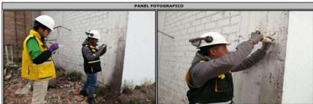
**OBSERVACIONES** PARA LA EJECUCIÓN DE LA PRUEBA DE ESCLEROMETRÍA SE TRABAJÓ EN ÁREAS SIN TABLAJE, SIN COBERTURA Y SIN ARMADURA. LA PRUEBA SE REALIZÓ CUMPLIENDO LAS EXIGENCIAS DE LA NORMATIVA, Y SE REALIZÓ EN PRESENCIA DEL SOLICITANTE.
