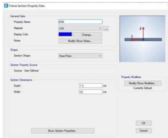
Figura 3.29 Asignación de placa de acero típico BRB en el Etabs
