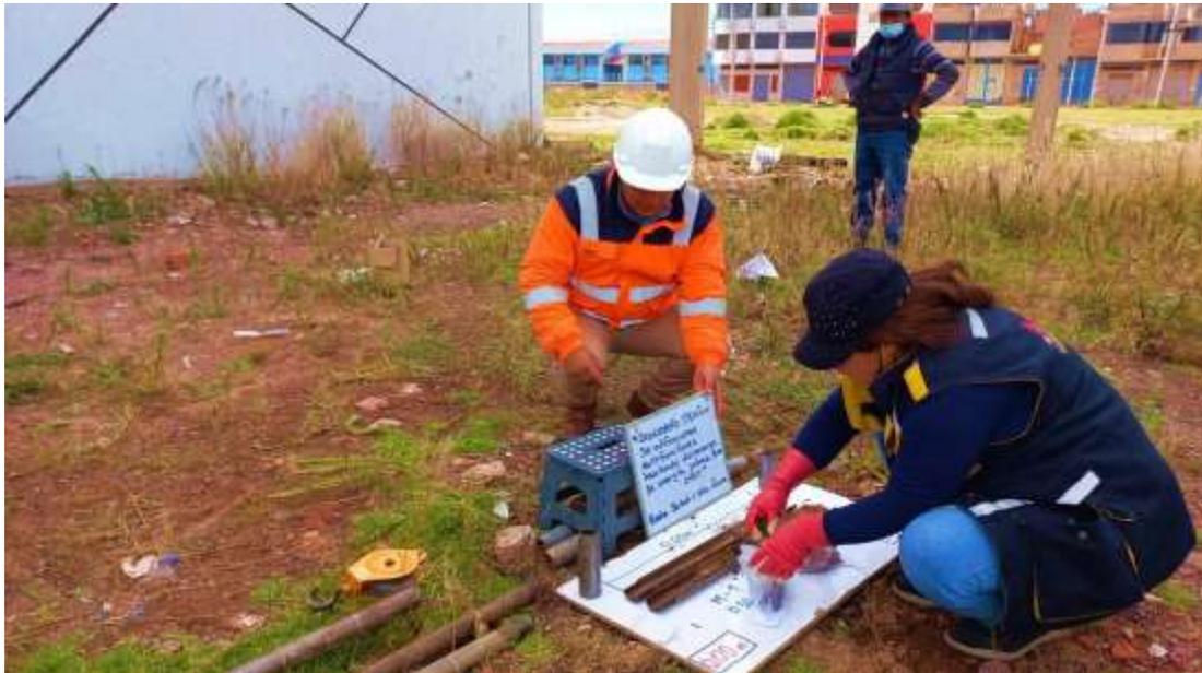
Figura 2 Ensayo de SPT
