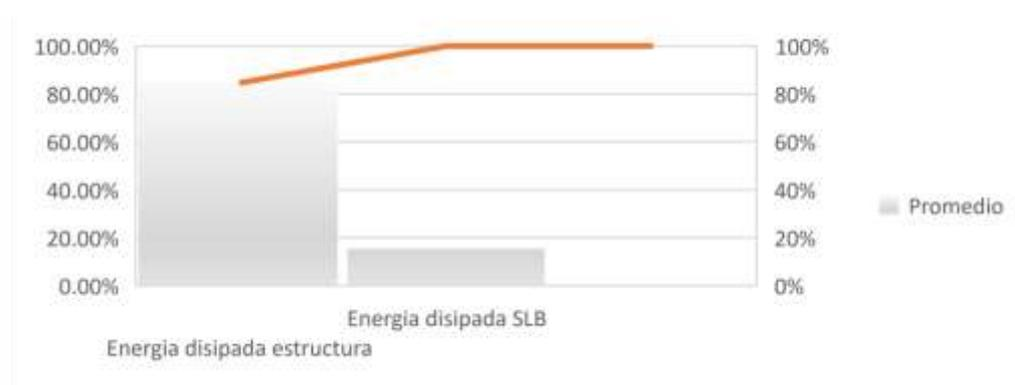
Figura 4.8 Porcentajes de disipación de energía c/s reforzamiento SLB promedio - N - S
