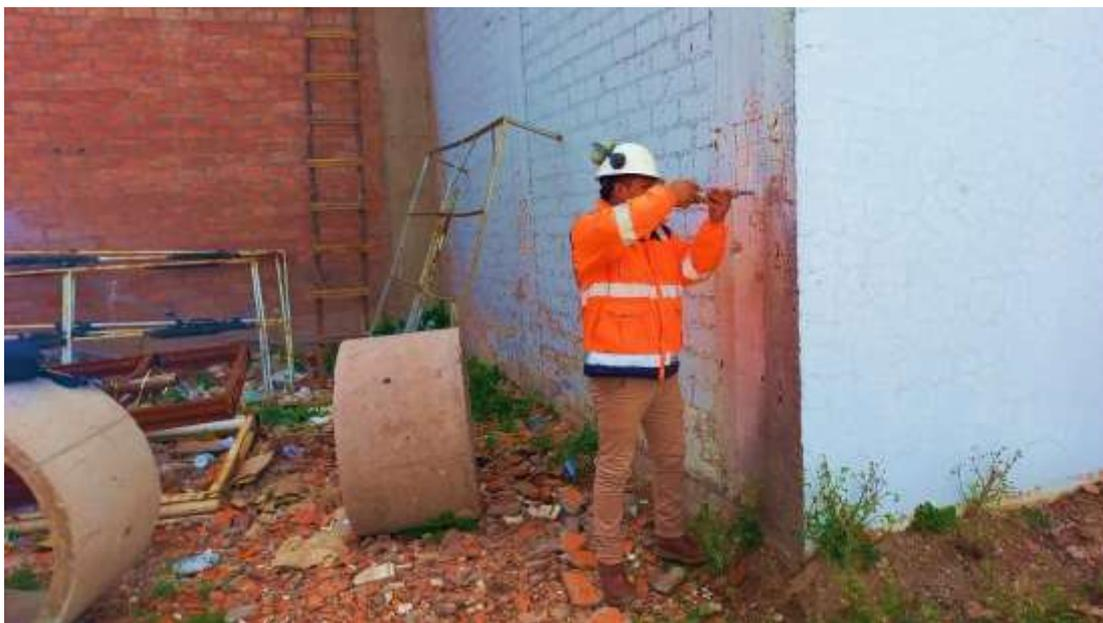
Figura 3 Ensayo de esclerometría
