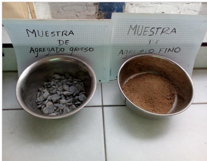
FIGURA 30: Agregados pesados con 40% piedra + 60% arena para elaboración de briquetas
