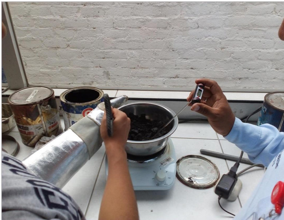
FIGURA 33: Control de temperatura de mezcla asfáltica – 170°C
