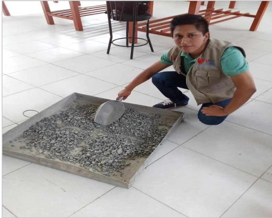
FIGURA 25: Selección de muestra de agregado grueso para los ensayos respectivos en laboratorio.
