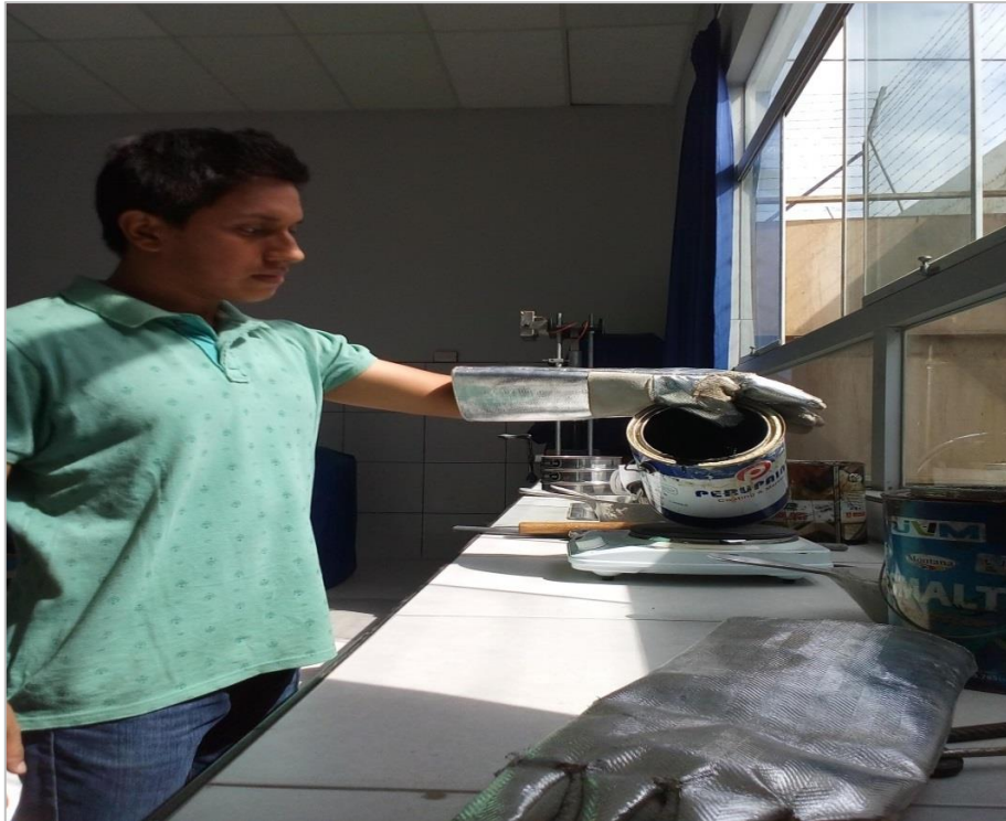
FIGURA 31: Diluido del cemento asfáltico PEN 60-70 modificado para su respectivo mezclado con los agregados
