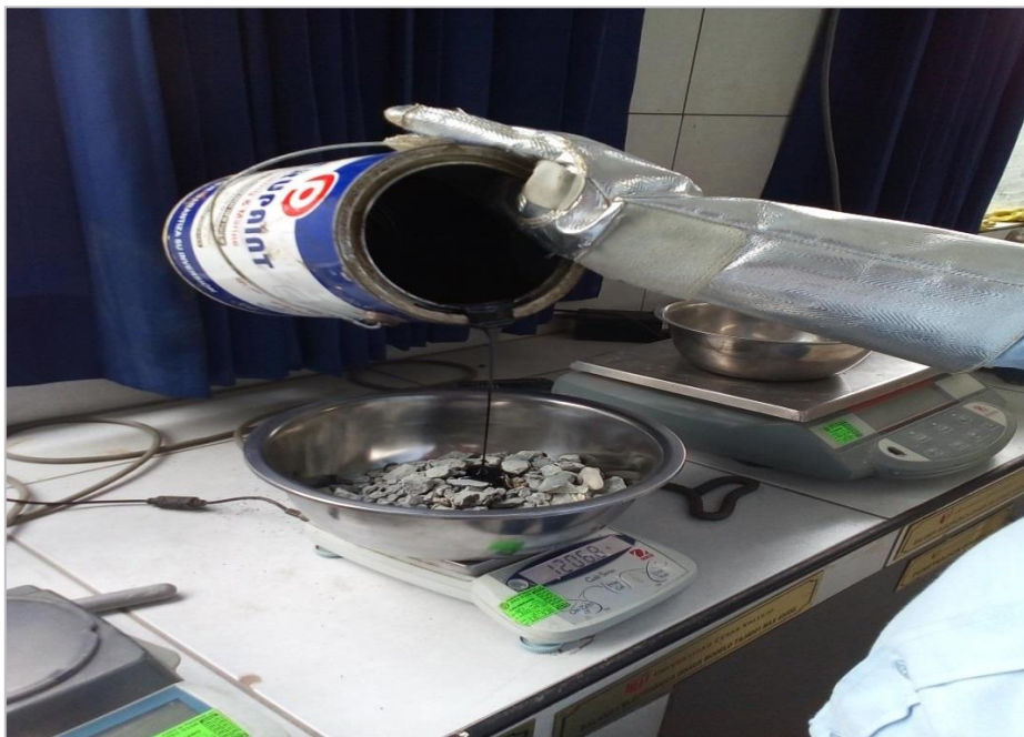
FIGURA 32: Mezclado de cemento asfáltico con agregados para dar como producto las briquetas
