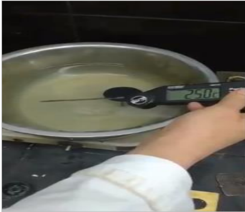
FIGURA 13: Baño maría: medición constante de la temperatura de 25°C – ensayo de penetración
