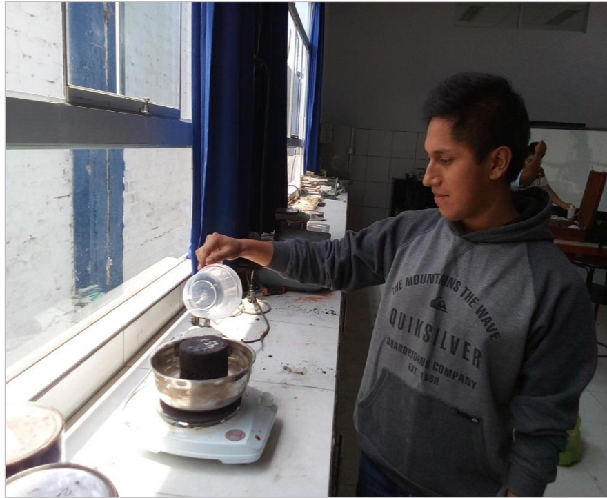
FIGURA 39: Preparación del baño maría a 60°C
