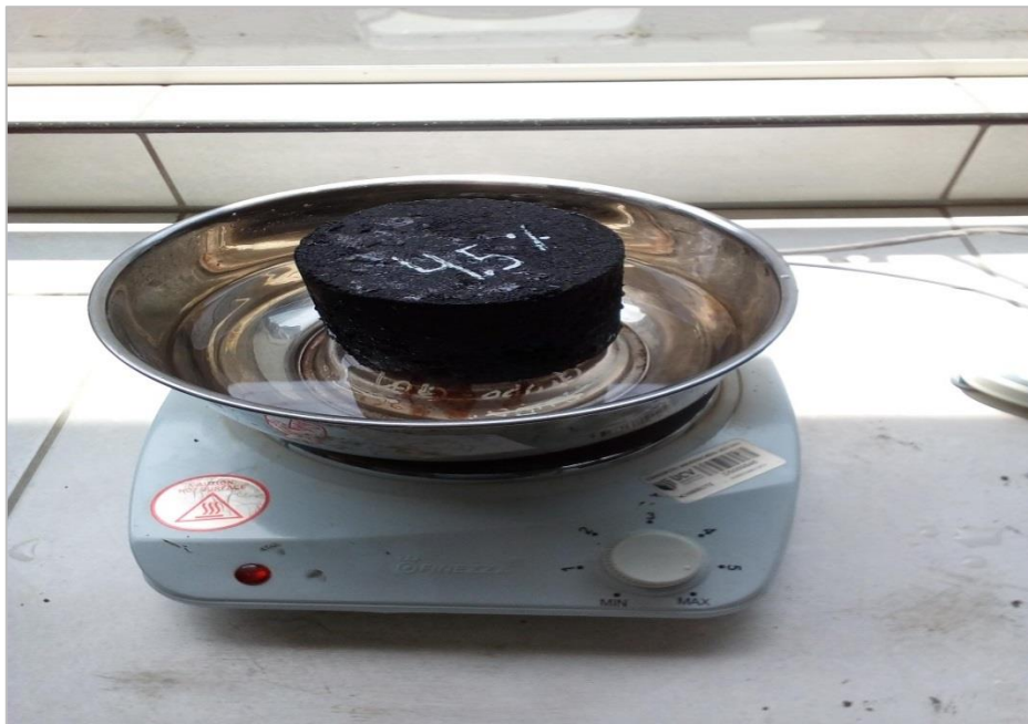
FIGURA 40: Briqueta expuesta al baño maría por 40 min para su posterior rotura
