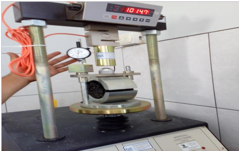
FIGURA 42: Determinación de la estabilidad y flujo en el ensayo Marshall
