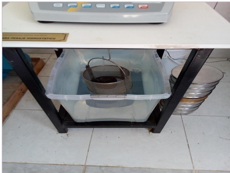
FIGURA 38: Determinación del peso de la briqueta sumergida en agua
