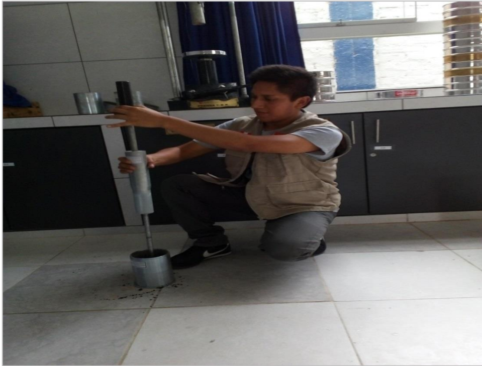
FIGURA 35: Compactación de la mezcla en caliente con 75 golpes por ambas capas
