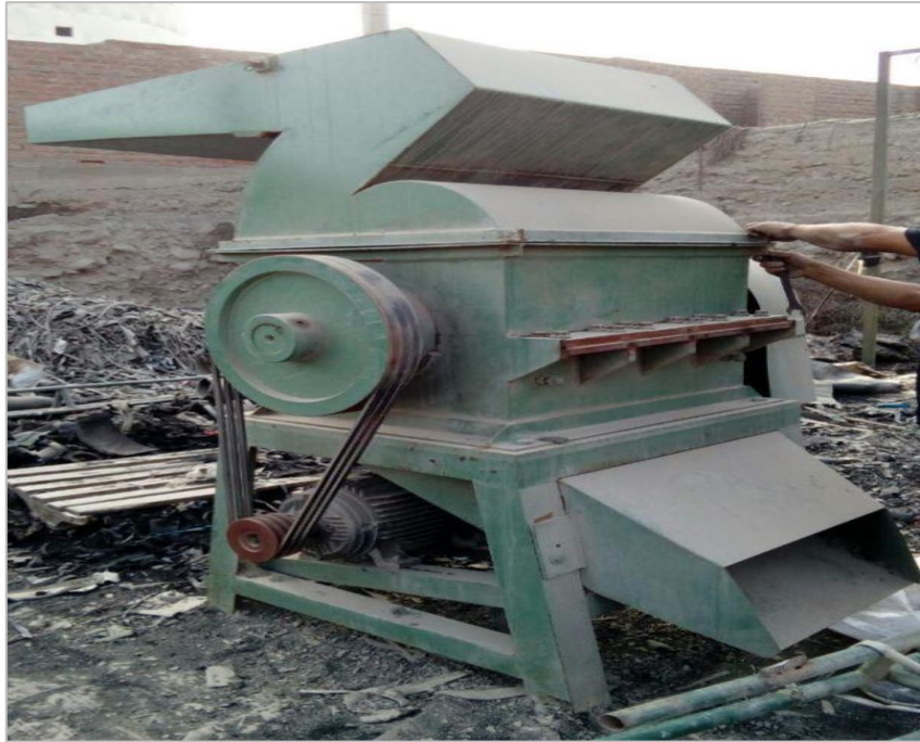
FIGURA 05: Máquina empleada de 20hp hasta 30hp para el triturado de hule reciclado
