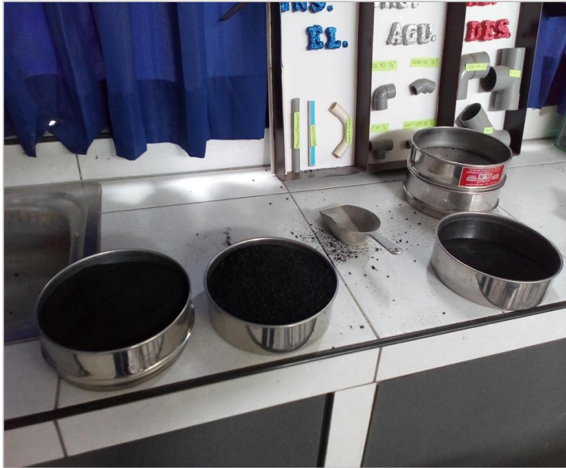
FIGURA 09: Obtención de los diámetros para combinación con el cemento asfáltico
