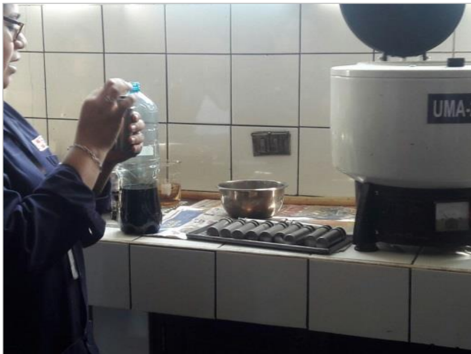
FIGURA 18: Determinando las cantidades de muestra de cemento asfáltico
