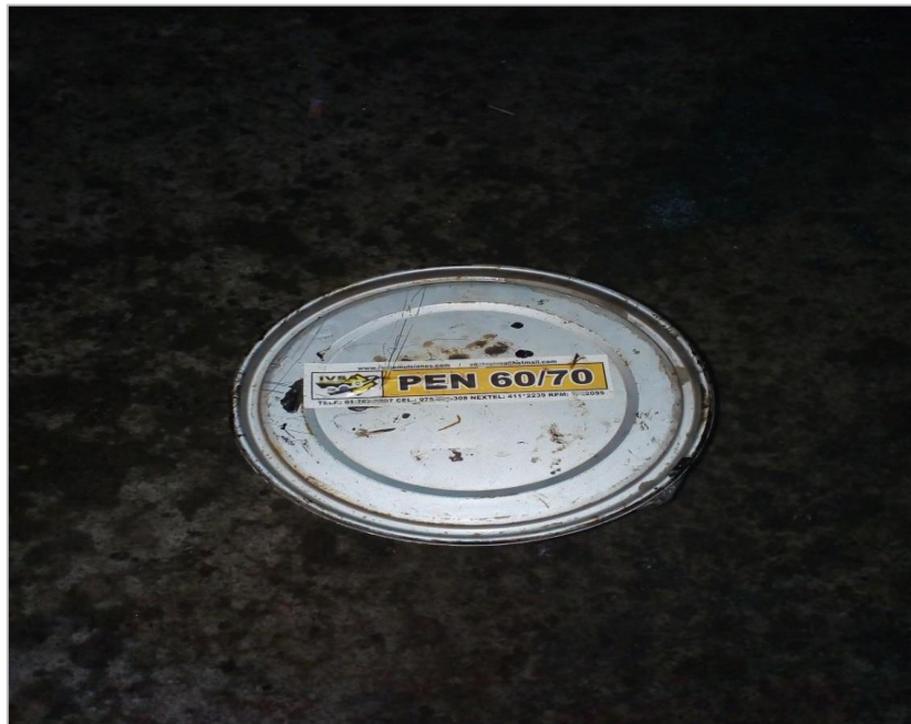
FIGURA 10: Cemento asfáltico utilizado pen 60/70 de Industrias KyC de la ciudad de lima
