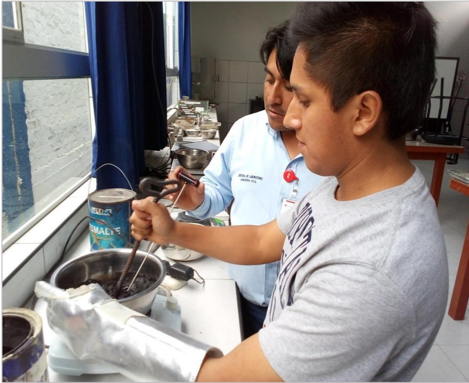
FIGURA 33: Combinación de materiales de la mezcla en caliente
