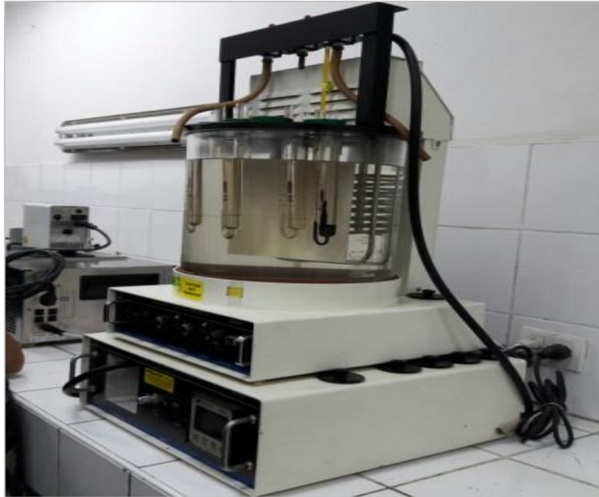
FIGURA 19: Equipo calibrado para ensayo de punto de ablandamiento
