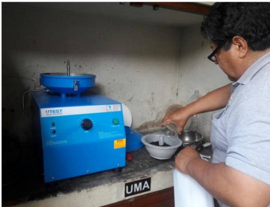
FIGURA 16: Preparación de las muestras para ensayo de punto de ablandamiento en la unidad de mezclas asfálticas (UMA) del laboratorio de estudios especiales del MTC
