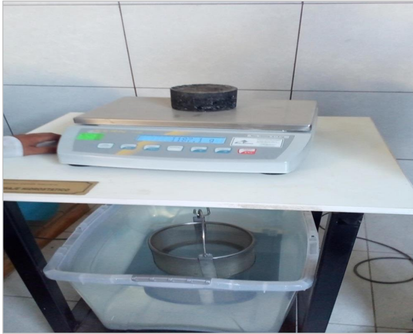
FIGURA 37: Determinación del peso de la briqueta seca en el aire
