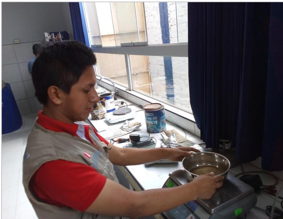
FIGURA 28: Determinación de los pesos de los agregados para la fabricación de las briquetas de asfalto
