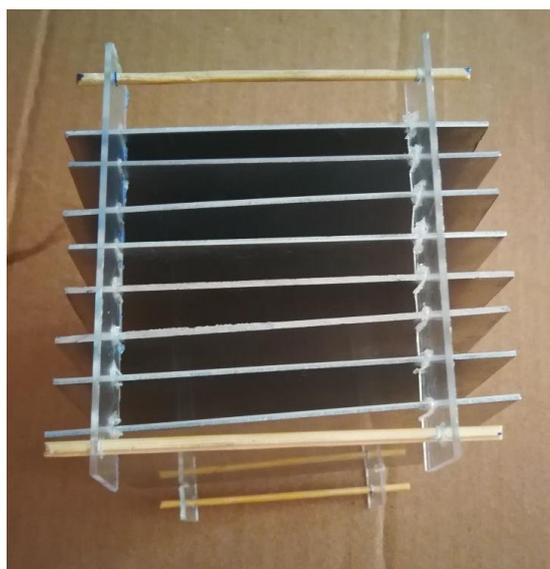
**Figura 7:** Soporte de electrodos
