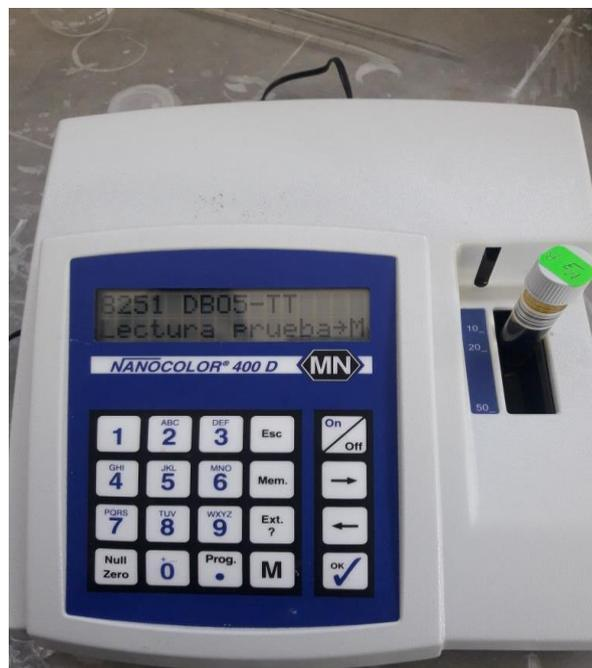
**Figura 17:** Medición de la absorbancia de DBO<sub>5</sub>.
