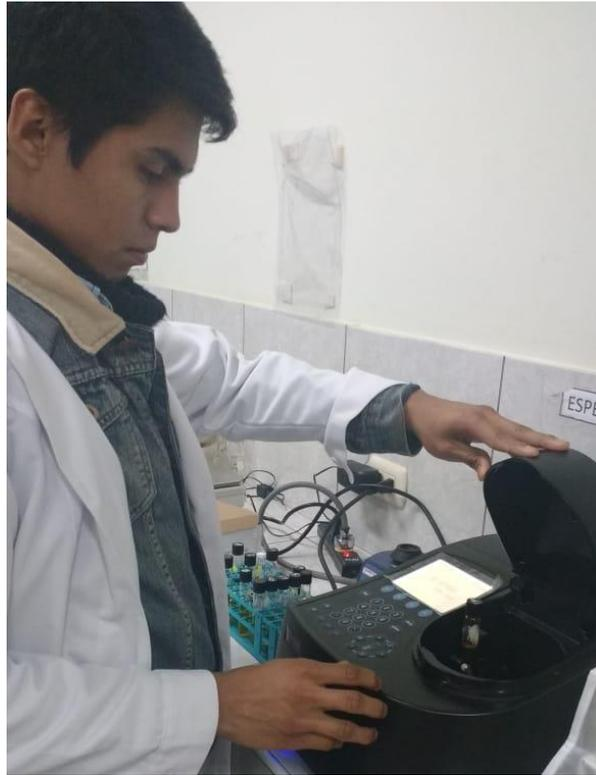
**Figura 16:** Medición de la absorbancia de DQO.
