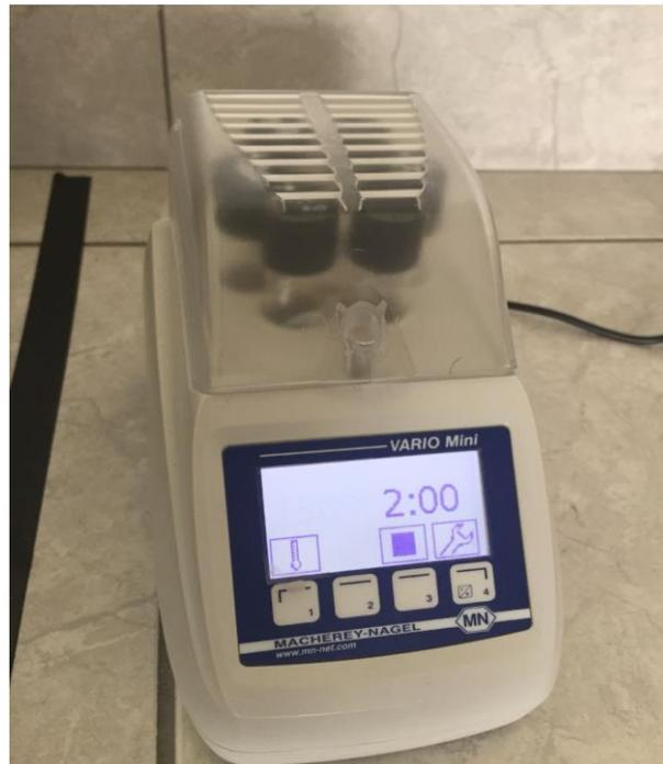
**Figura 15:** Digestor con viales para medición de DQO.
