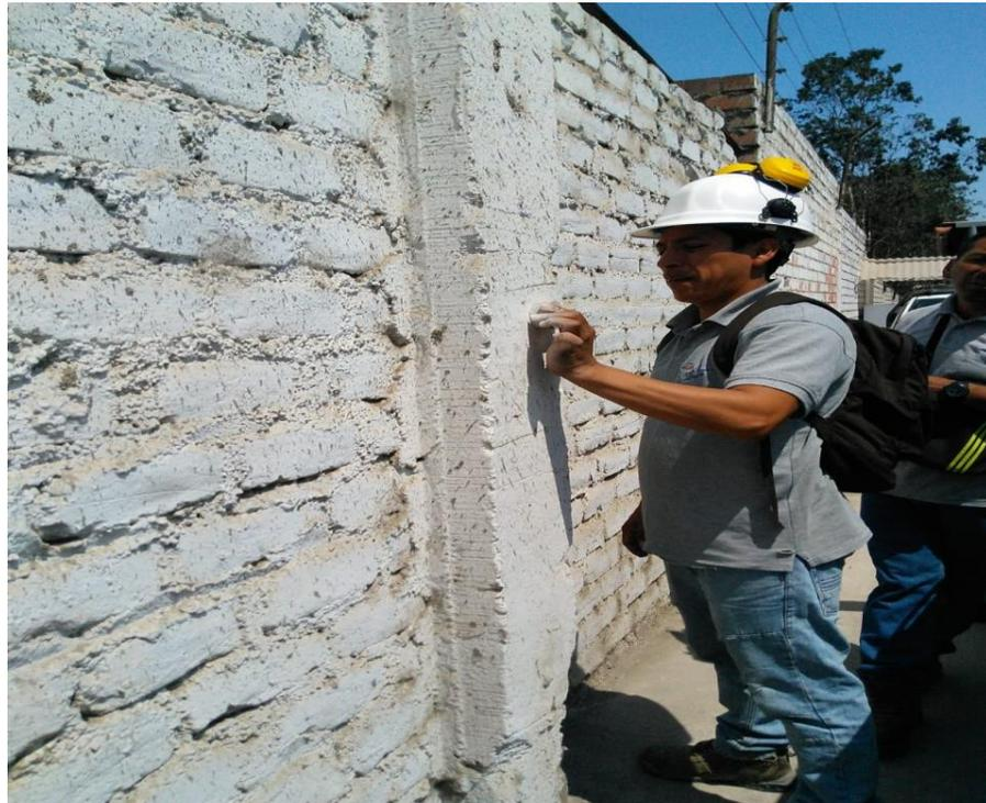
**Figura N°33:** Elección de prueba y lijado de columna.
