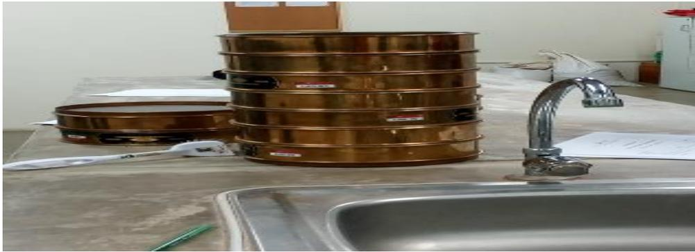
**Figura N°31:** Empleo de malla por tamizado.
