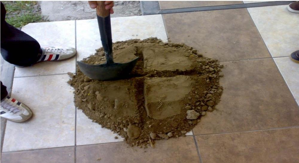
**Figura N°29:** Cuarteo de material de muestra extraído de calicata
