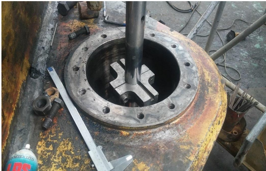
Figura: 14 Pre Maquinado de Alojamiento
