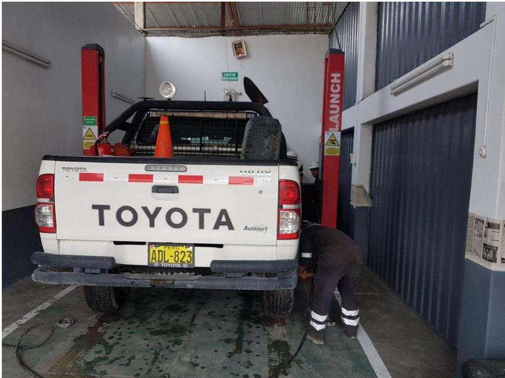
Figura 12. Personal mecánico realizando desmontaje de neumático.
