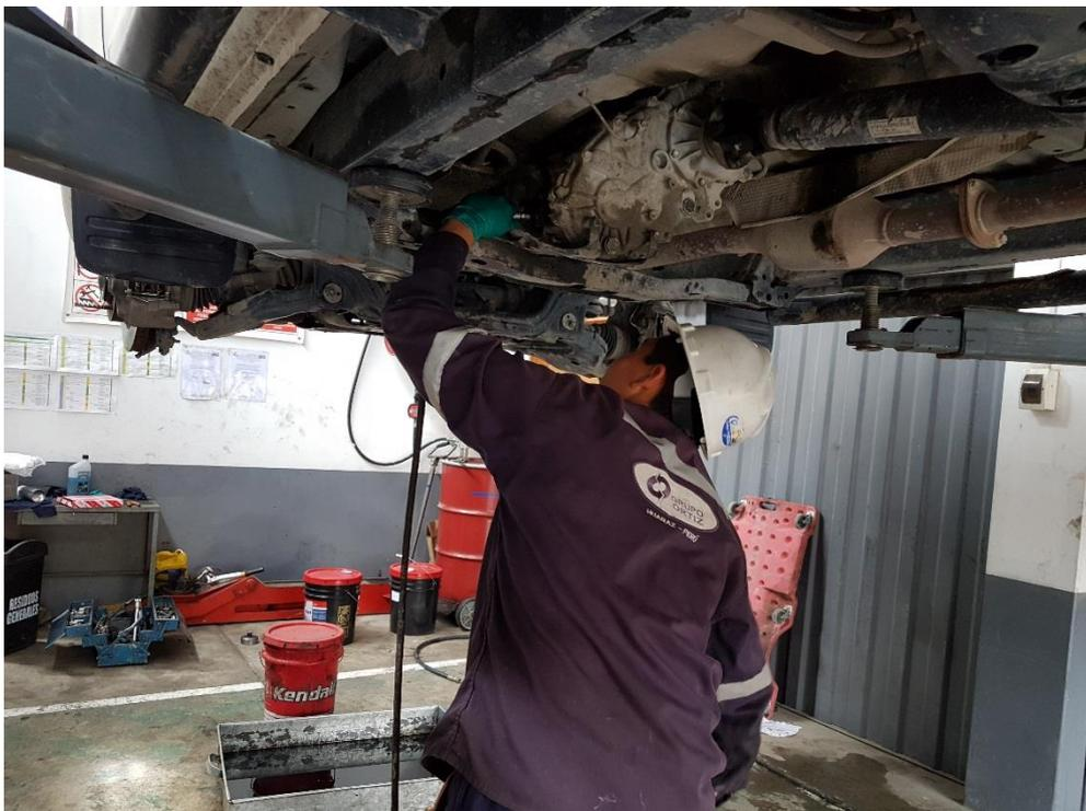
Figura 9. Personal mecánico realizando lubricación de árbol de transmisión.
