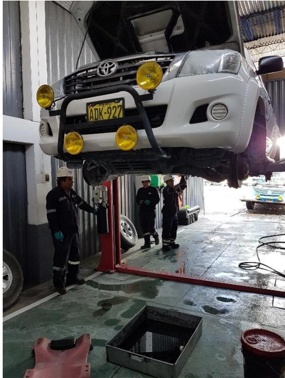
Figura 10. Personal mecánico realizando izaje del vehículo.
