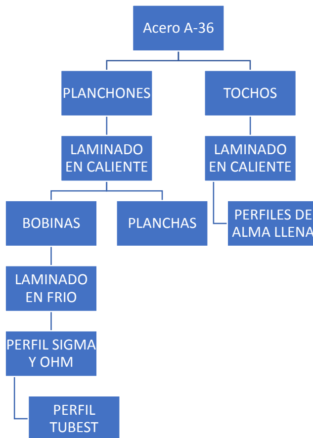
Figura 28 Resumen de procesos de fabricación de los sistemas Tubest y alma llena
