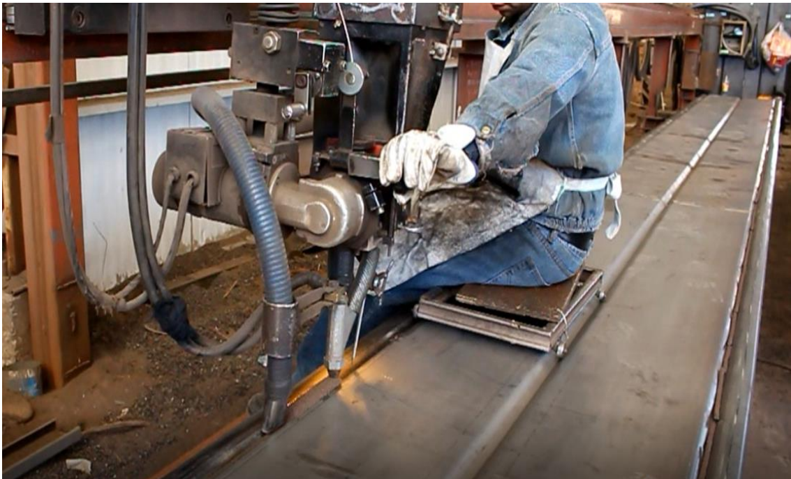
Figura 36 Soldadura con arco sumergido del perfil Tubest
