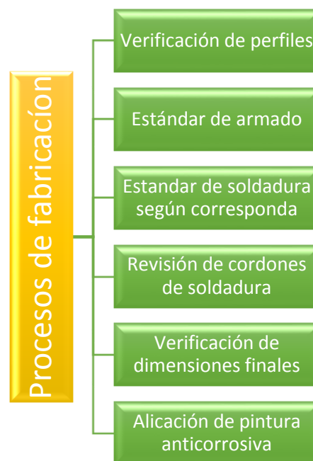
Figura 6. Procesos de fabricación del sistema Tubest.
