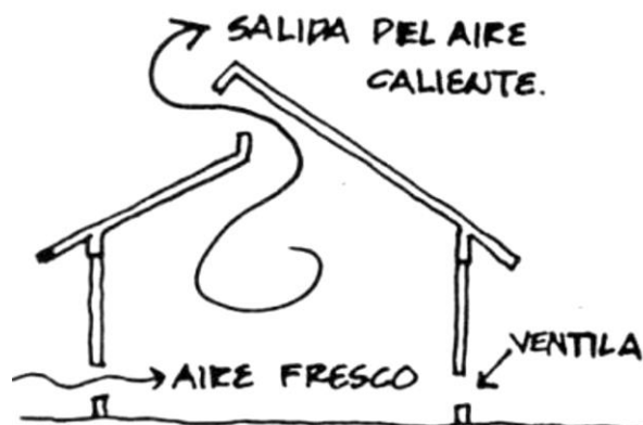
Figura 78. Efecto chimenea (termosifón).
