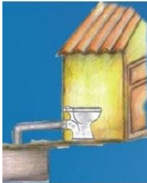
Figura 138. Interior del baño ecológico con biodigestor.
