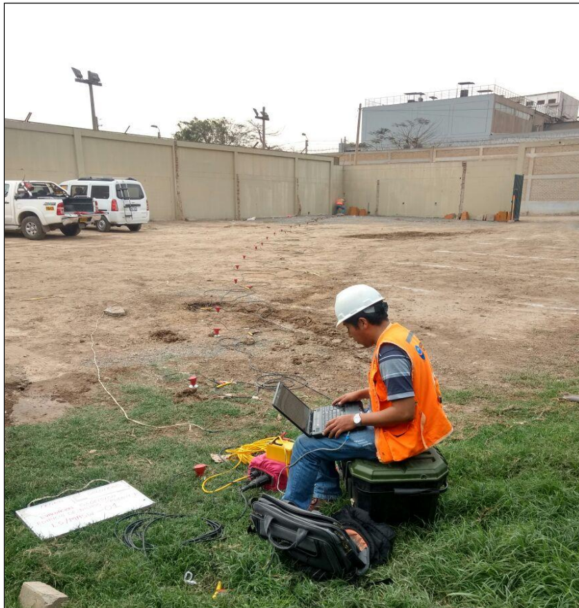
FIGURA N° 7: Línea de Refracción Sísmica (Fuente: Propia, 2017)
