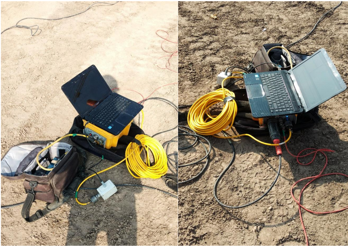
FIGURA N°11: conexión de cables de geofonos y disparador conectados (Fuente: Propia, 2018)
