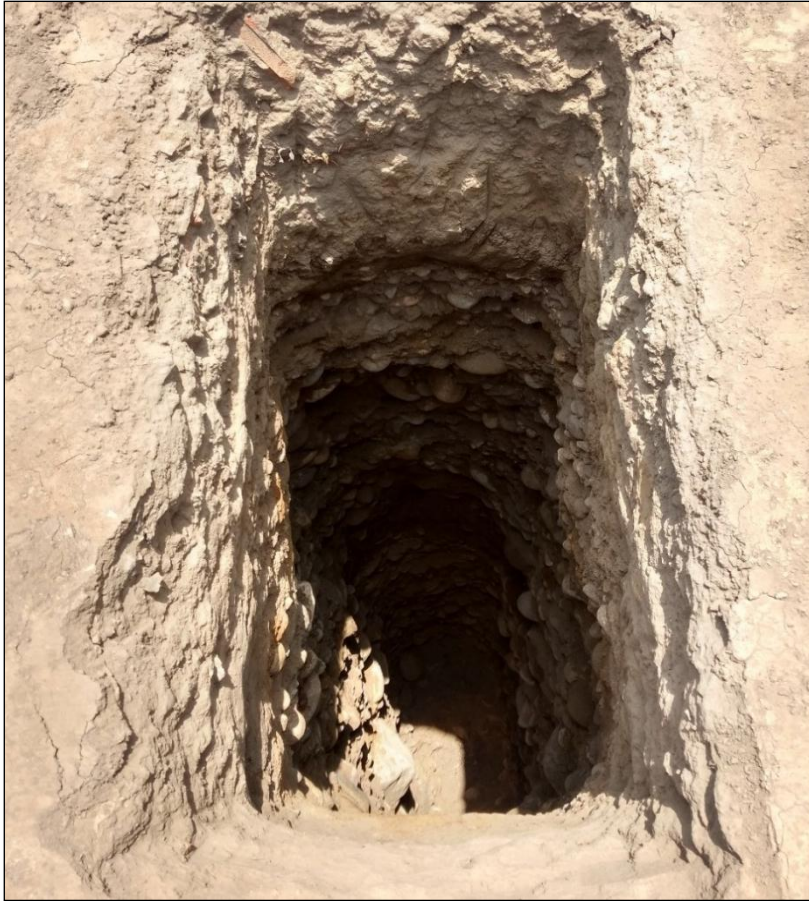
FIGURA N°2: Calicata excavada de forma manual. (Fuente: propia, 2017)
