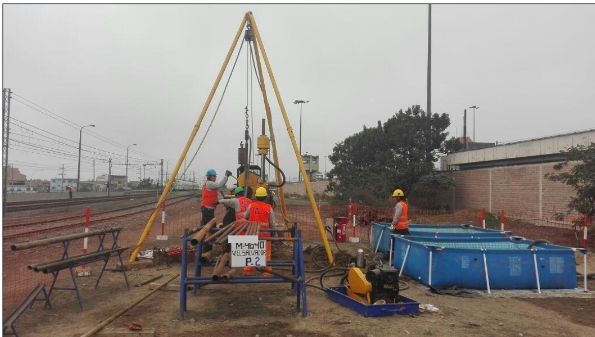
FIGURA N°17: Perforación Rotativa (Fuente: MyM, 2017)
