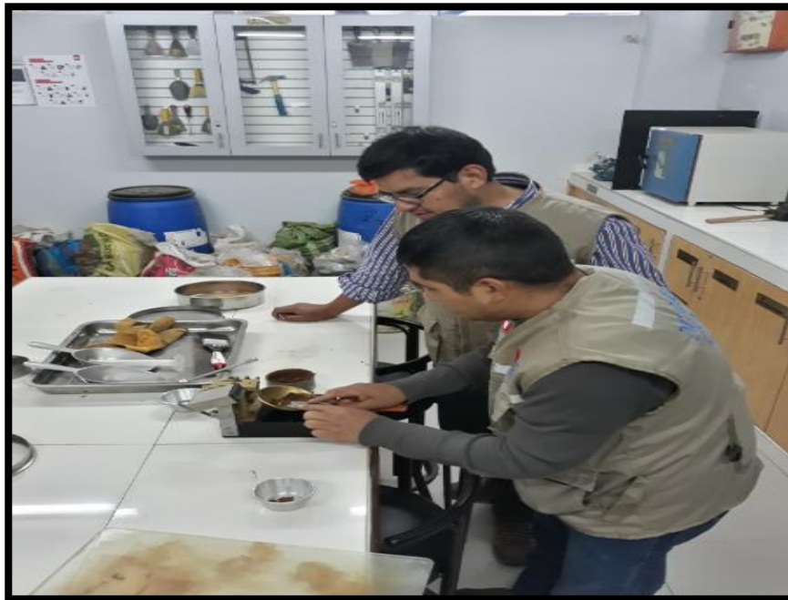
REALIZANDO EL ENSAYO DE LÍMITE LÍQUIDO
