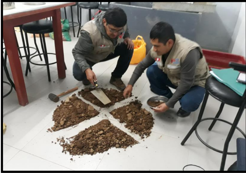
TOMANDO LA MUESTRA PARA REALIZAR EL ENSAYO DE GRANULOMETRÍA
