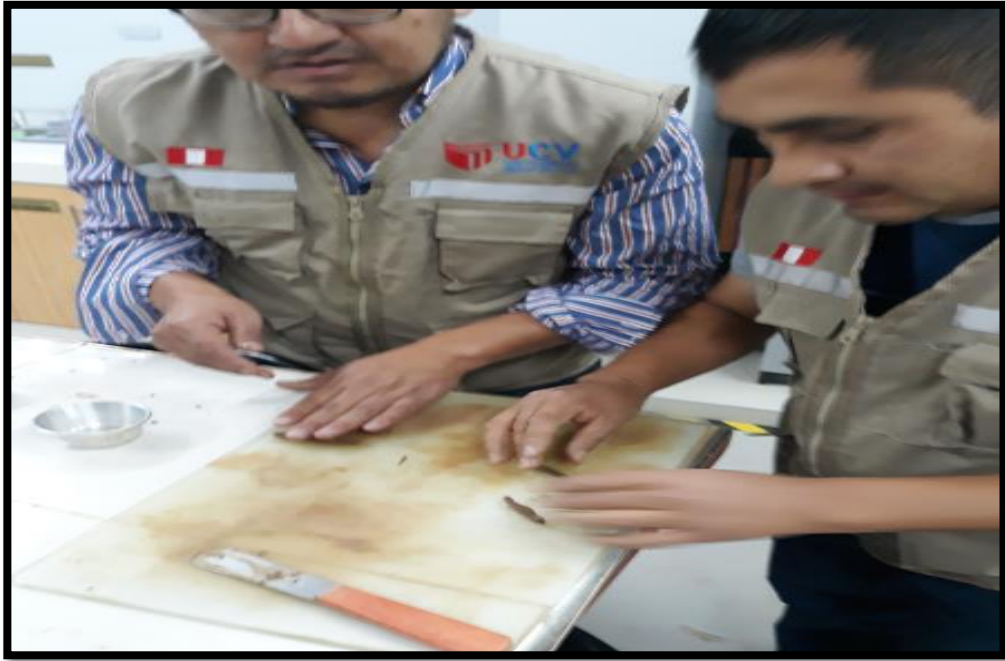
REALIZANDO EL ENSAYO DE LÍMITE PLÁSTICO
