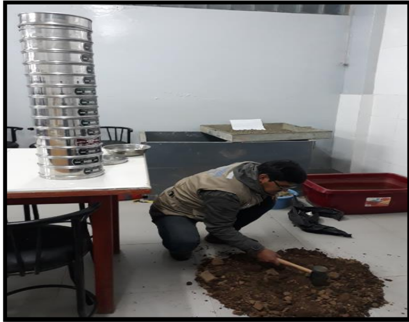
PREPARANDO LA MUESTRA PARA REALIZAR EL CUARTEO
