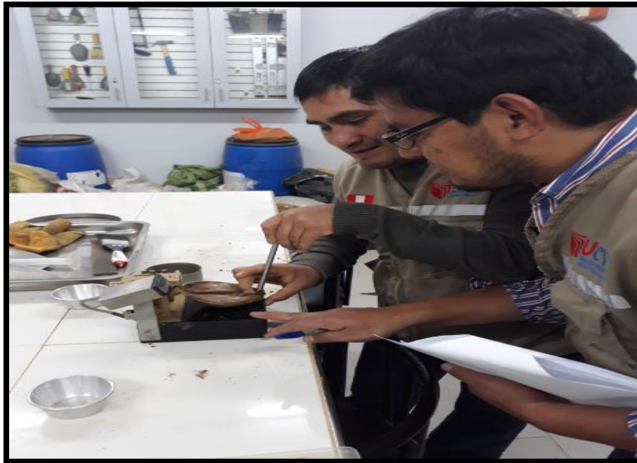
REALIZANDO EL CORTE EN LA MUESTRA EN LA COPA DE CASAGRANDE
