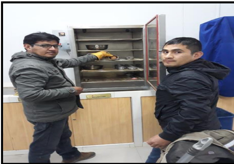
COLOCANDO LAS MUESTRAS EN LAS TARAS, AL HORNO DURANTE 24 HORAS
