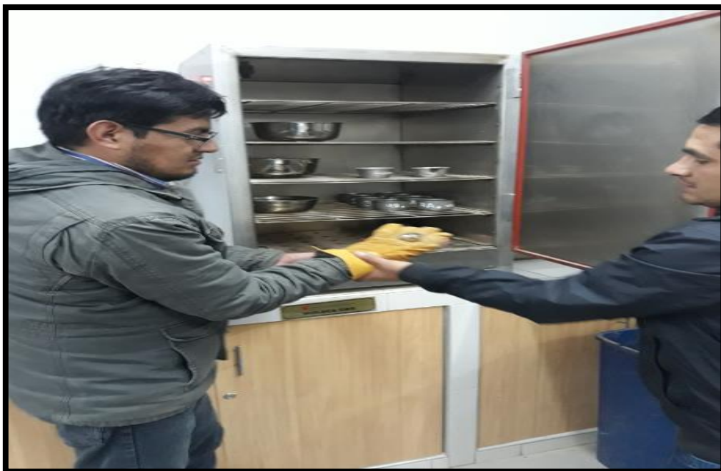
SACANDO DEL HORNO LAS MUESTRAS COLOCADAS PARA DETERMINAR EL LÍMITE PLÁSTICO
