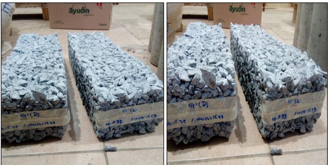
Figura 28: Viguetas de Concreto Permeable para ensayos a Flexión
