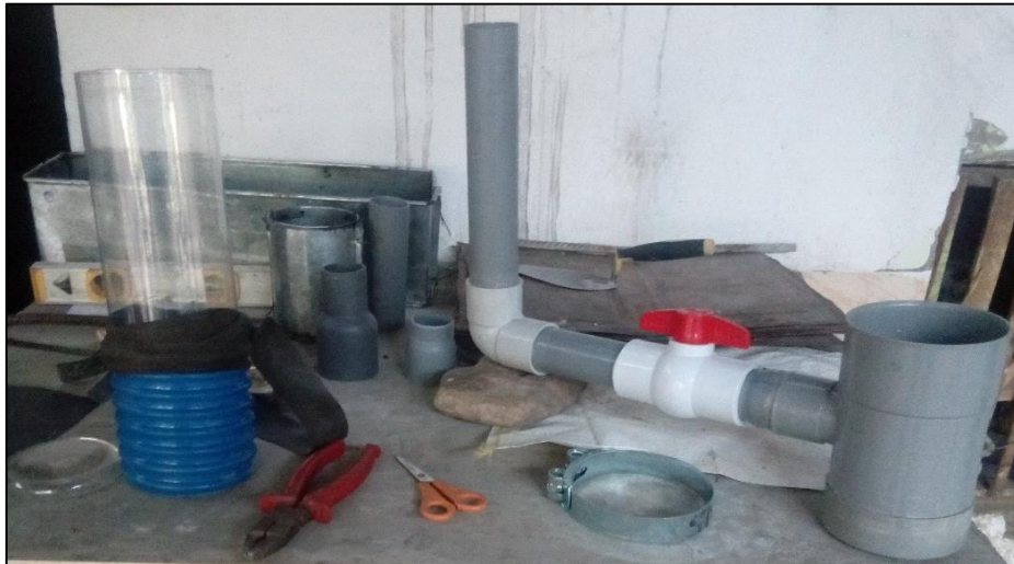
Figura 18: Elaboración de equipo de permeabilidad
