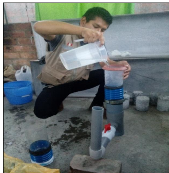
Figura 34: Ensayo de Permeabilidad a probetas con gradaciones de 1/2" y 3/8"
