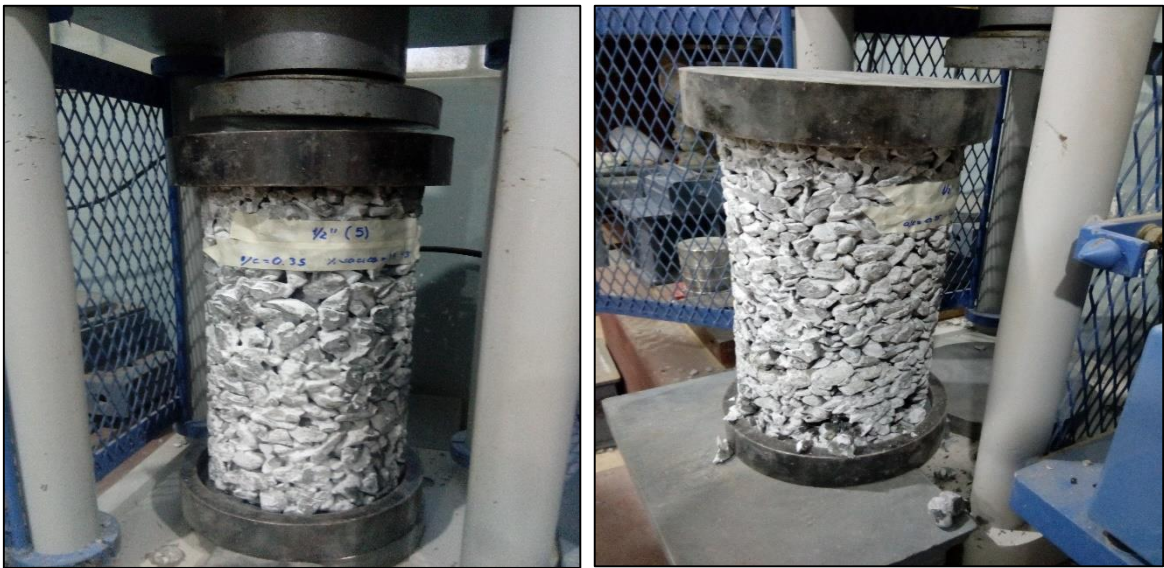
Figura 30: Ensayo a Compresión de Probetas con gradación de 1/2"
