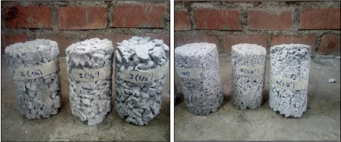
Figura 29: Probetas de Concreto Permeable para ensayos de Permeabilidad
