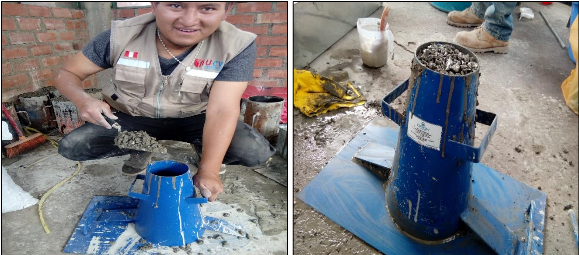
Figura 24: Ensayo de Asentamiento de Concreto Permeable
