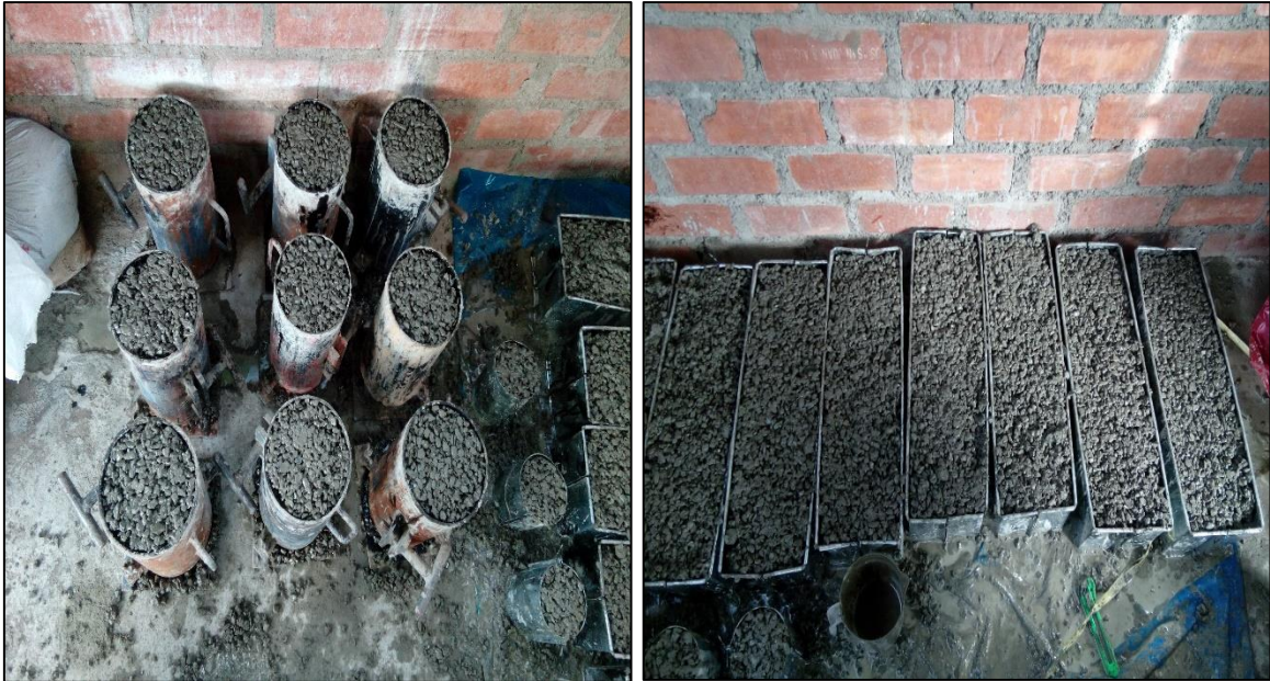
Figura 23: Elaboración de especímenes de Concreto Permeable
