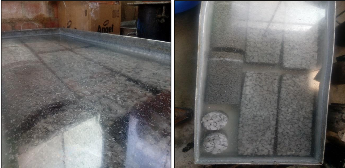
Figura 26: Curado estándar de especímenes de Concreto Permeable
