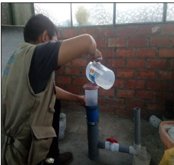
Figura 34: Ensayo de Permeabilidad a probetas con gradaciones de 1/2" y 3/8"
