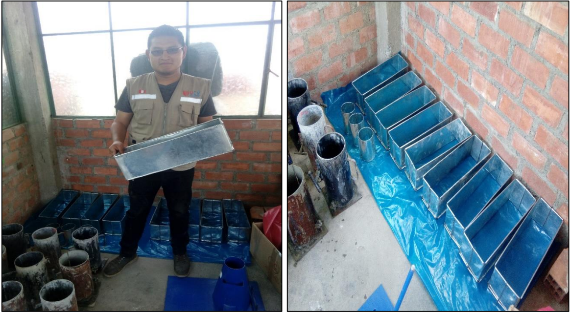
Figura 20: Moldes para realizar Probetas y Viguetas de Concreto Permeable
