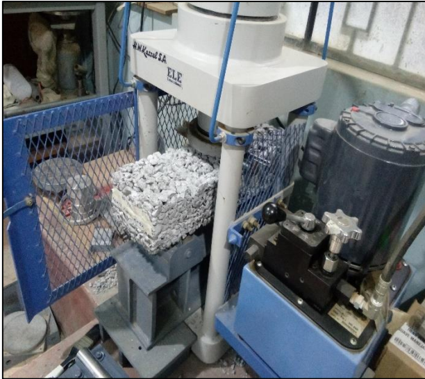
Figura 32: Ensayo a Flexión de viguetas con gradación de 1/2"
