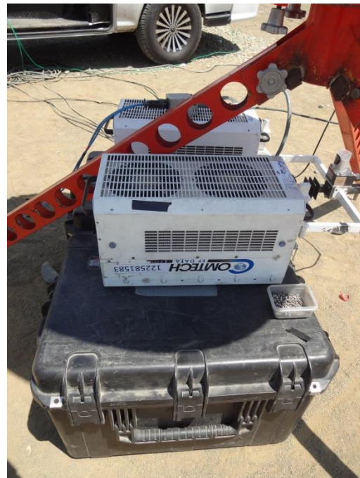
Foto N° 07: Moduladores, Encoder, IRD
