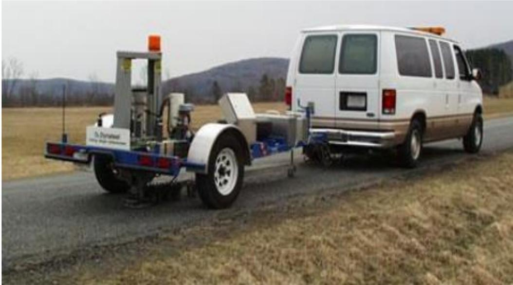
Figura 1-6: Deflectómetro de Impacto (FWD). Fuente: RAMCODES 2015.
