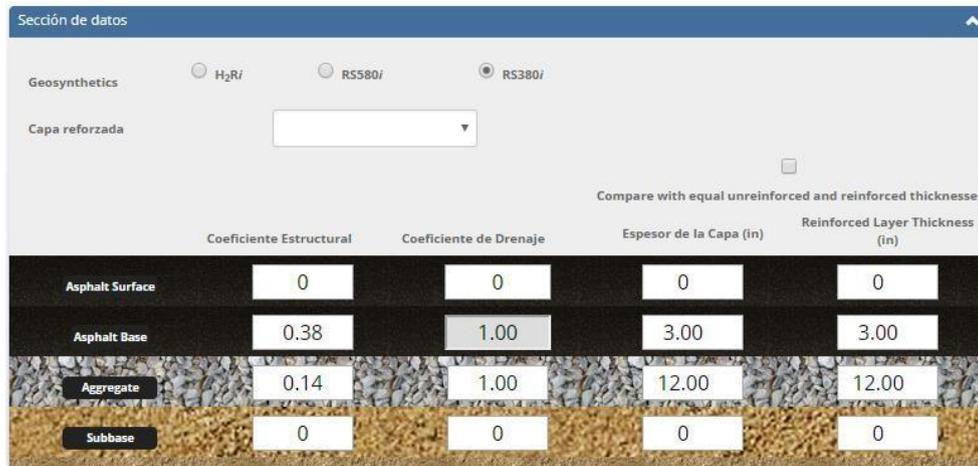
Figura 3-29: Uso del software de diseño de pavimentos flexibles TenCATE
