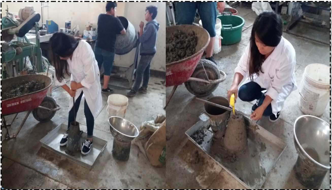
Figura 20: Ensayo de asentamiento o Slump
