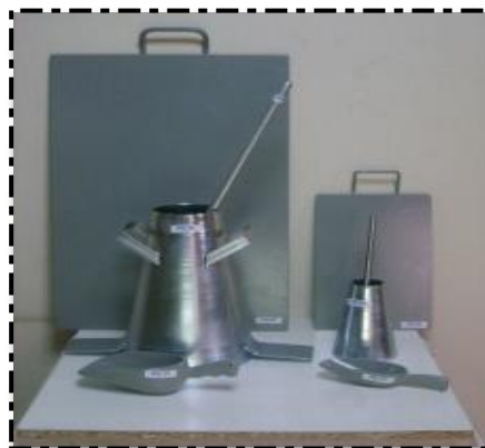
Figura 9: Equipo de cono de Abrams
