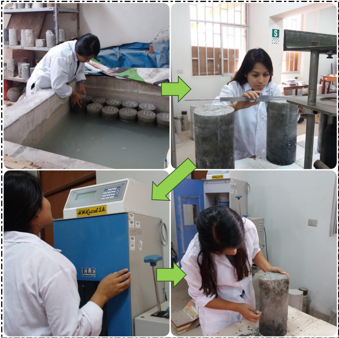
Figura 21: Proceso de rotura de probetas
