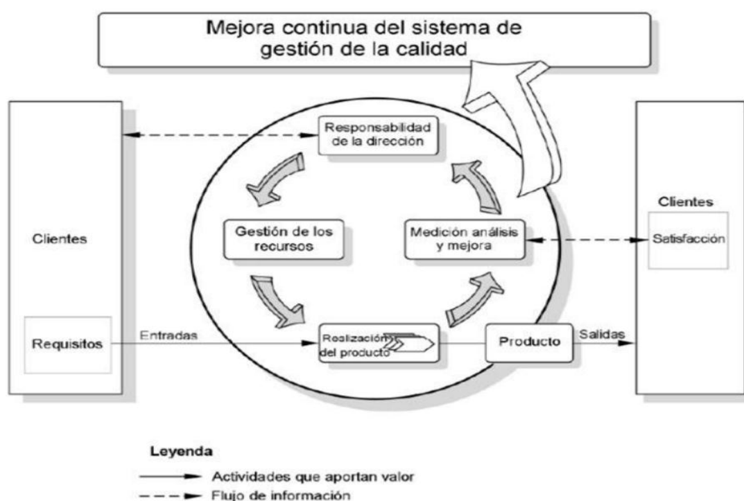
Figura 2. Modelo de un sistema de gestión de la calidad basado en procesos (tomado de la Norma ISO 9000:2000). Cantón (2010, p. 5).
