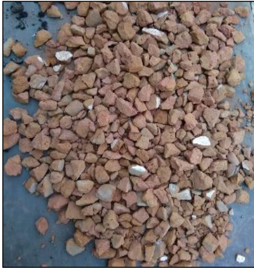
Figura 32: Material demolido de arcilla cocida
