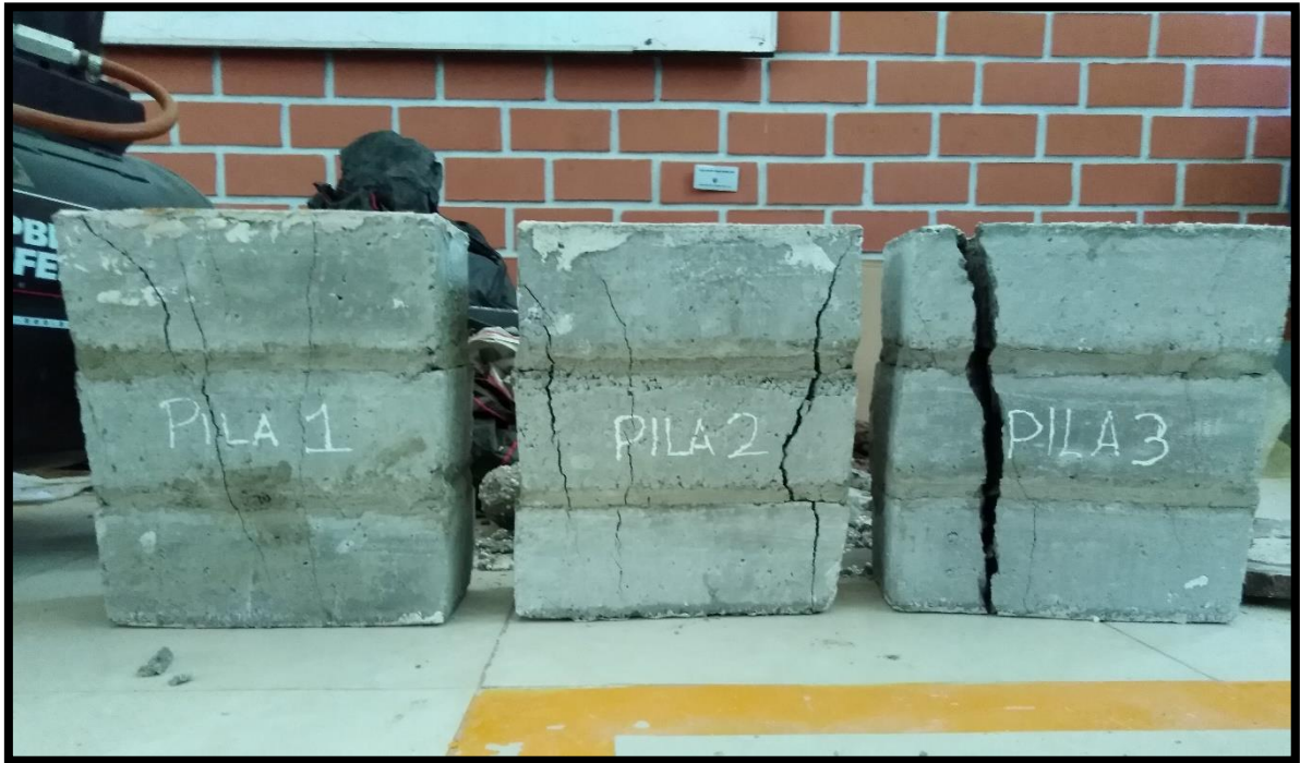
Vista donde se observa las tres pilas despues de la reslización del ensayo.
