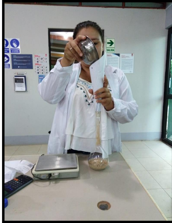
Imagen donde se puede apreciar a la tesista realizando el ensayo de peso unitario.
