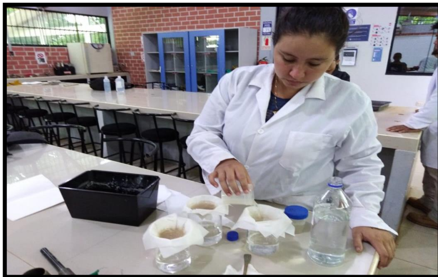
Realización del ensayo de sales soluble, cloruros y sulfatos
