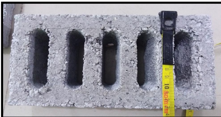
Se observa la corroboración del alto del ladrillo 2 King Kong tipo 14 (13 cm).
