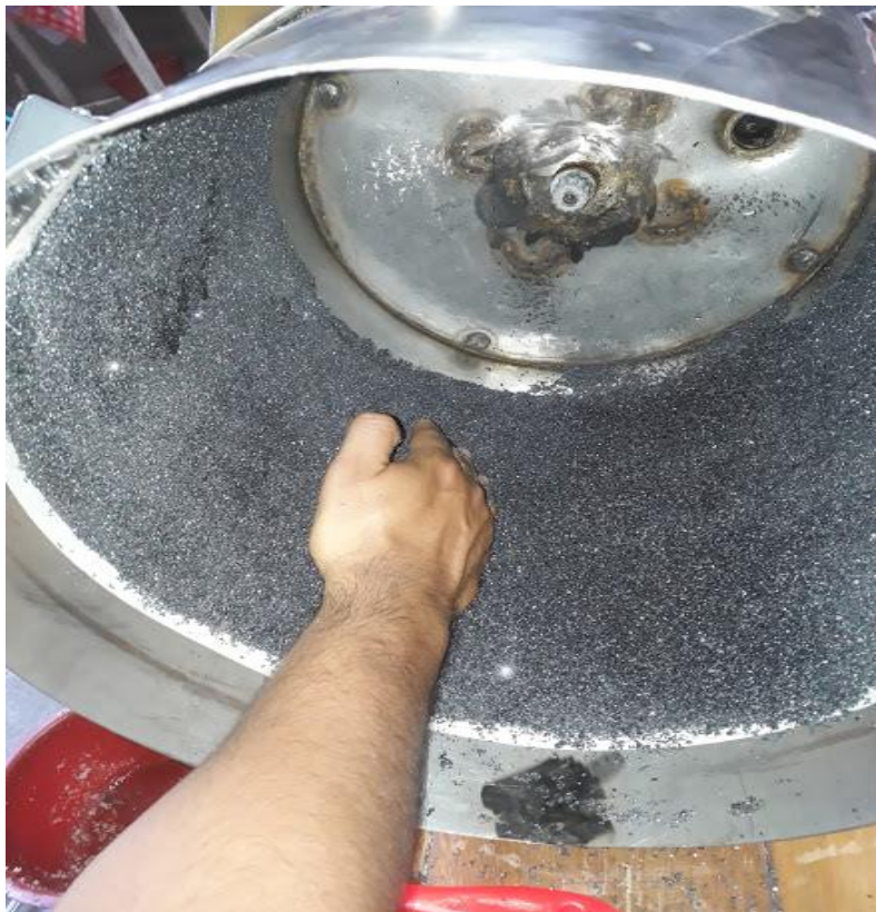
Imagen 9. Montaje del abrasivo con resina sintética
