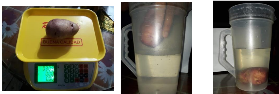
Figura 3. Medición de la masa y el volumen de la papa
