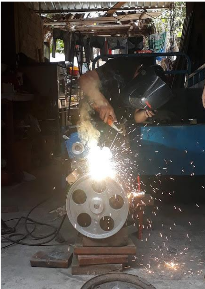
Imagen 11. Soldadura de la base del motor
