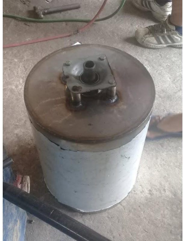
Imagen 5. Montaje de la base del eje
