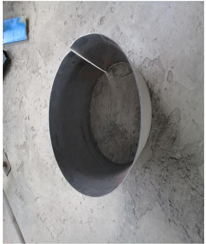
Imagen 2. Rolado de la plancha de acero inoxidable.
