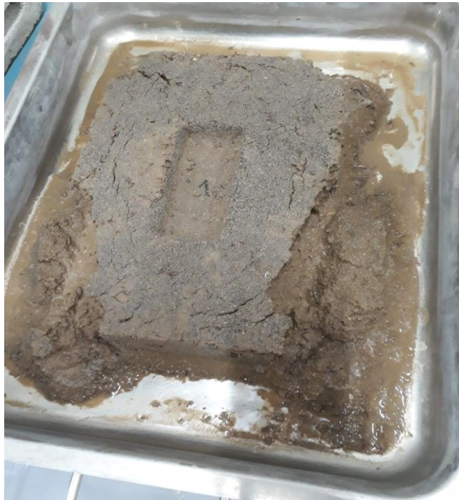
Fotografía 43. Ensayo de absorción del adobe con 0% de fibra vegetal
