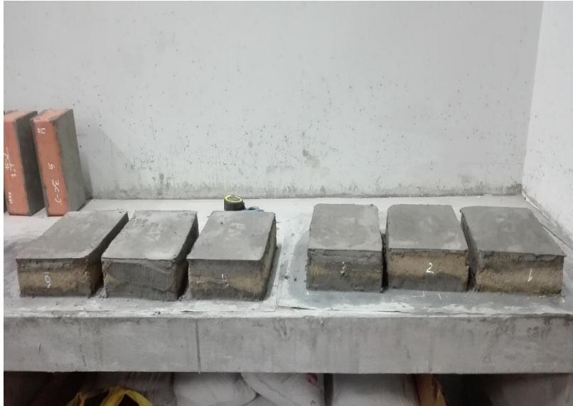
Fotografía 21. Capeado de la unidad de muestra
