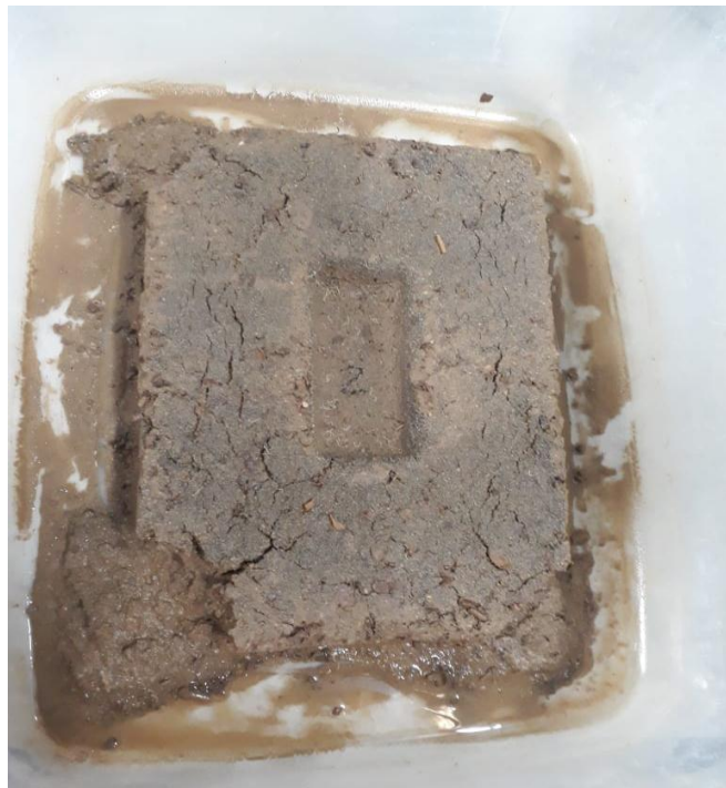
Fotografía 44. Ensayo de absorción del adobe con 1.5% de viruta
