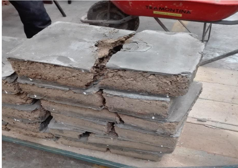
Fotografía 39. Resumen de adobes estabilizados con 3.0% de viruta de eucalipto
