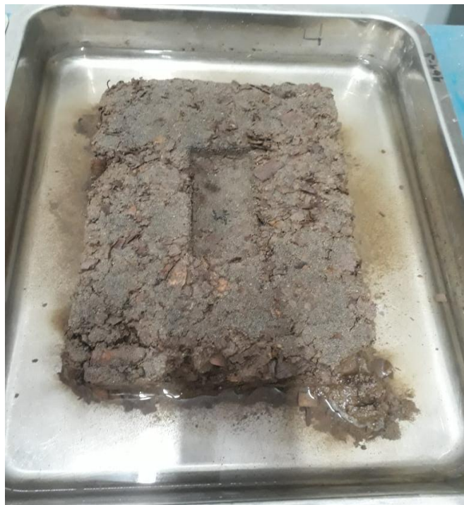
Fotografía 46. Ensayo de absorción del adobe con 4.5% de viruta
