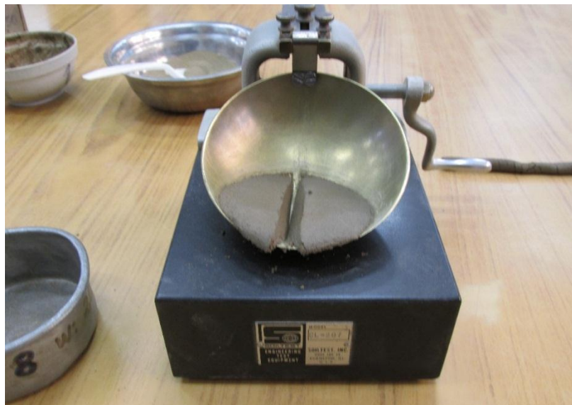
Fotografía 4. Ensayo en la copa de Casa Grande
