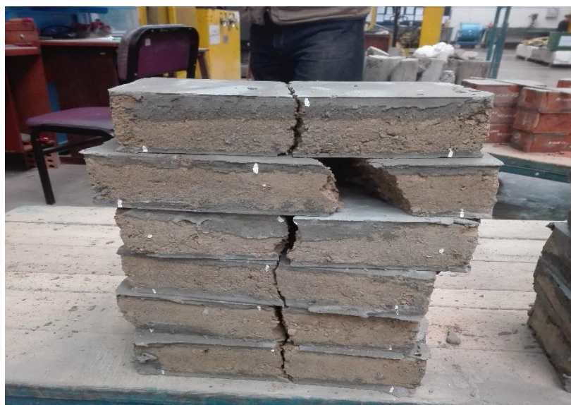
Fotografía 36. Resumen de adobes estabilizados con 1.5% de viruta de eucalipto
