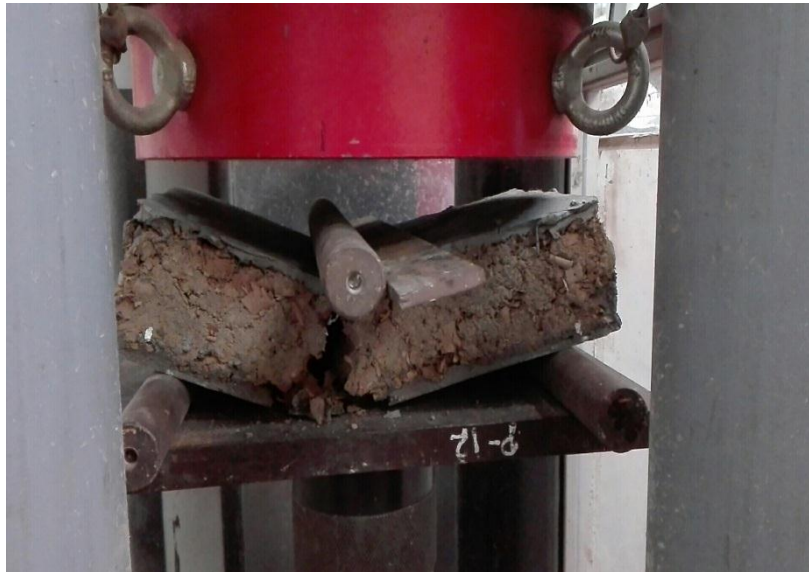
Fotografía 41. Módulo de rotura del adobe estabilizado con 4.5% de viruta de eucalipto
