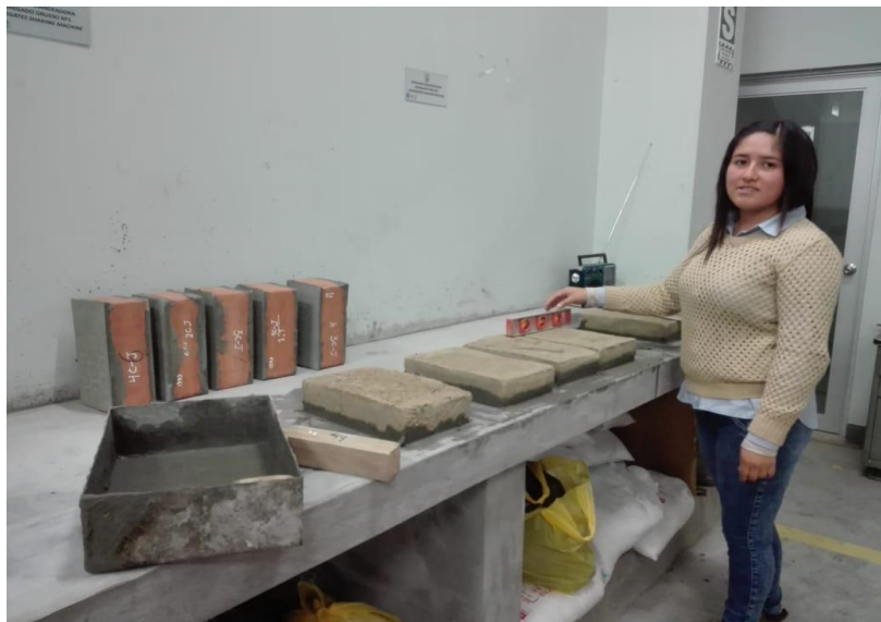
Fotografía 20. Nivelado de las muestras con yeso
