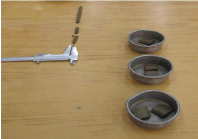
Fotografía 5. Comprobación de presencia de arcilla
