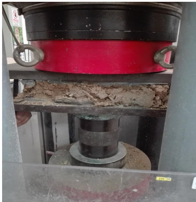
Fotografía 30. Resistencia a compresión del adobe estabilizado con 4.5% de viruta de eucalipto
