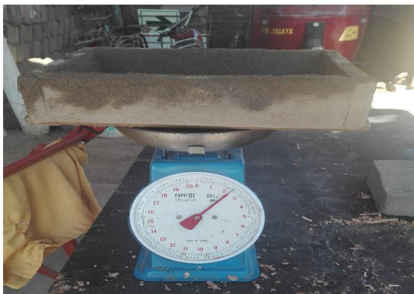
Fotografía 7. Peso de la adobera
