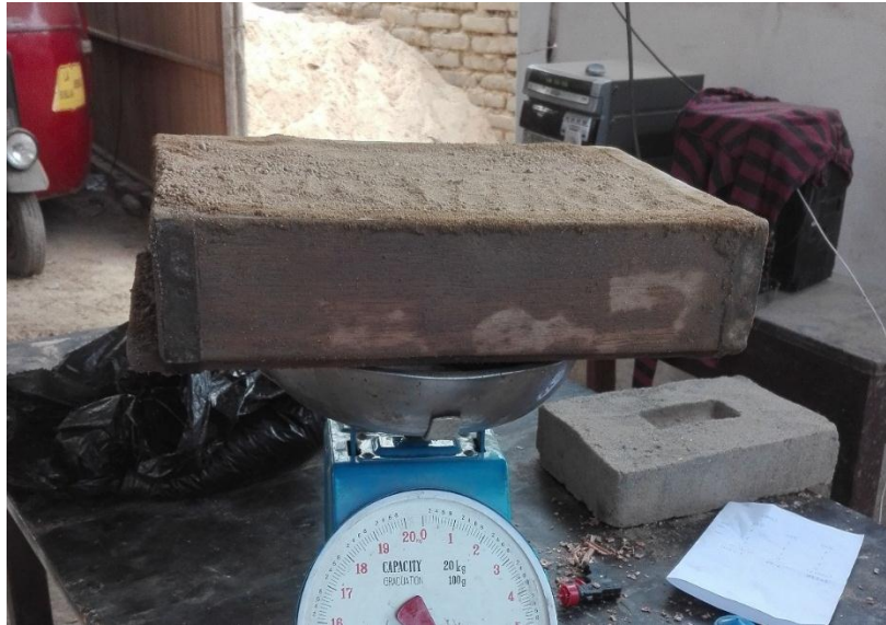
Fotografía 6. Peso de la muestra del suelo + adobera
