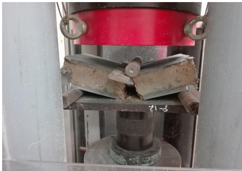
Fotografía 35. Módulo de rotura del adobe estabilizado con 1.5% de viruta de eucalipto
