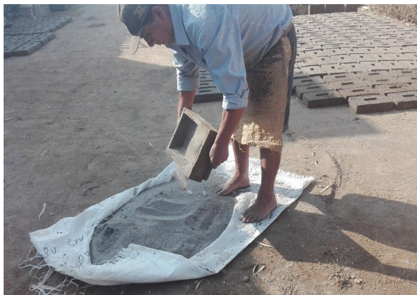
Fotografía 14. Agregado de arena en la adobera
