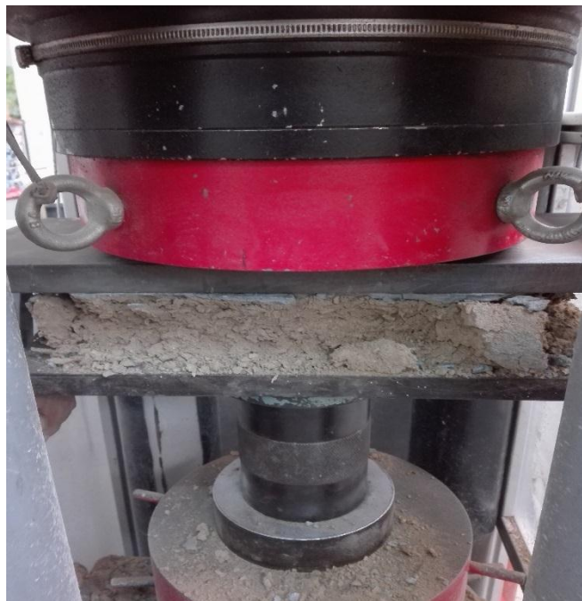
Fotografía 26. Resistencia a compresión del adobe estabilizado con 1.5% de viruta de eucalipto
