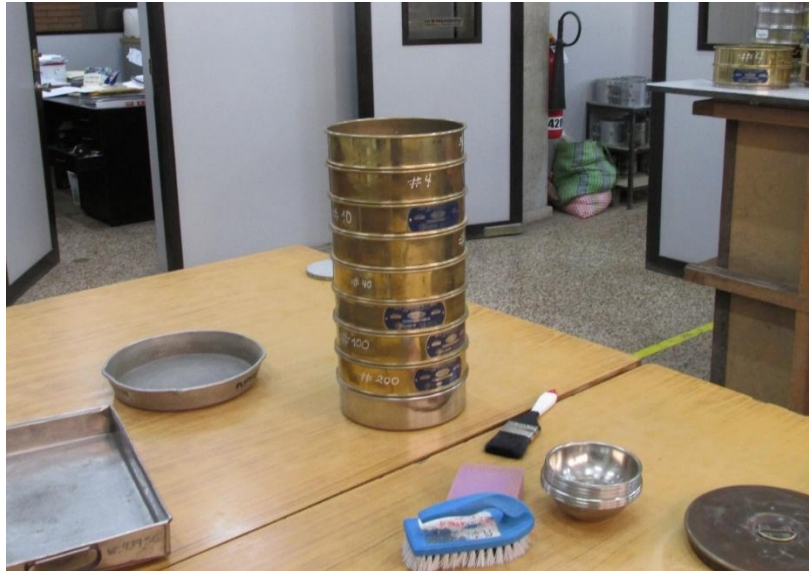
Fotografía 1. Tamizado de la muestra
