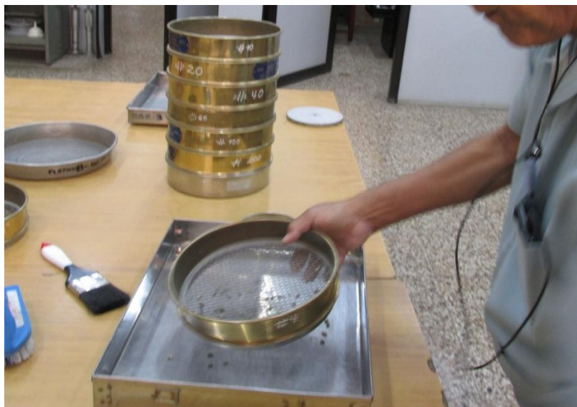
Fotografía 2. Muestra del suelo que pasa la malla n°200
