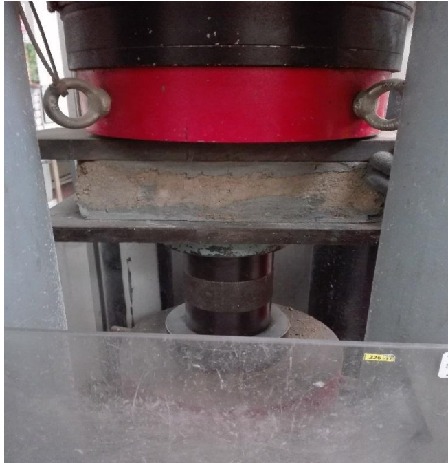
Fotografía 27. Unidad de estudio con 3.0% de viruta de eucalipto
