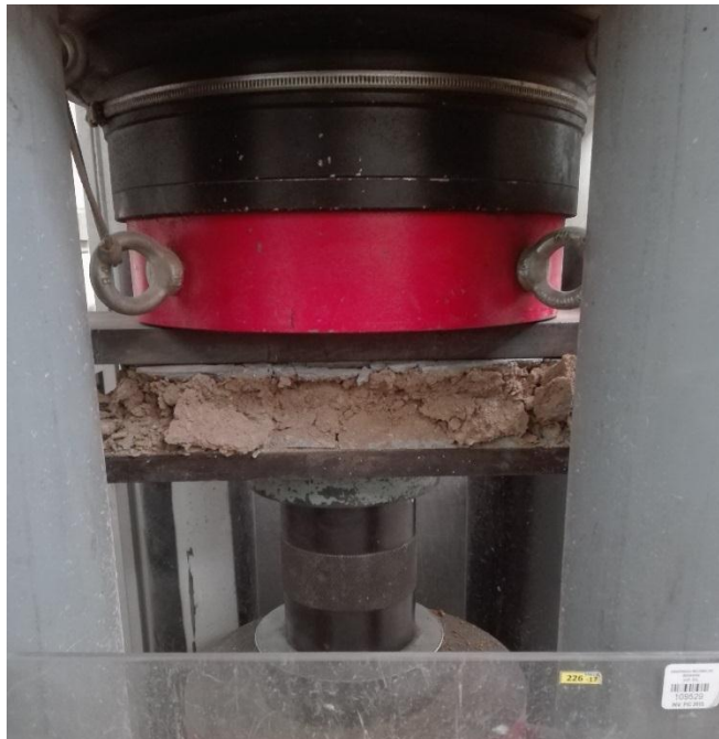
Fotografía 28. Resistencia a compresión del adobe estabilizado con 3.0% de viruta de eucalipto
