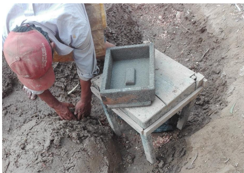
Fotografía 15. Fabricación del adobe
