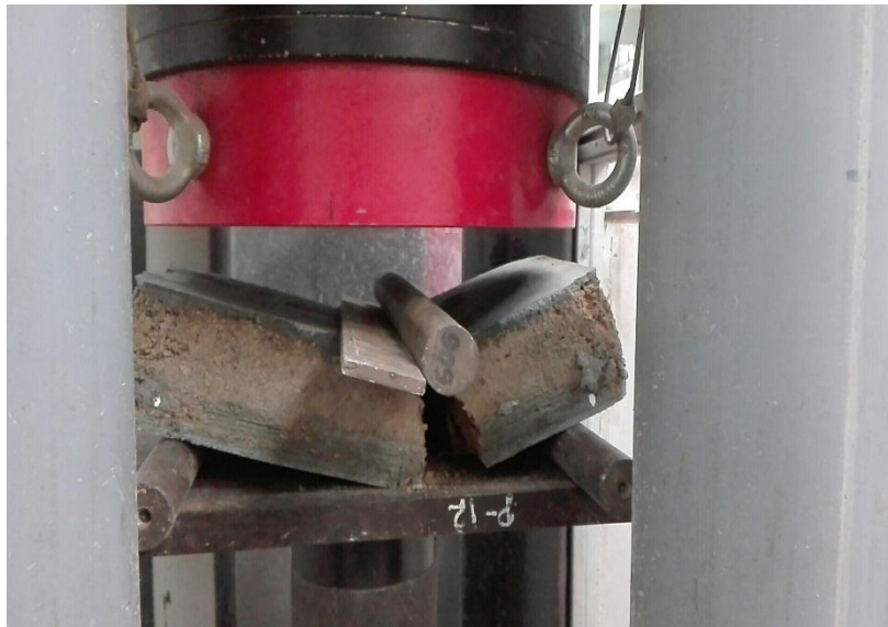
Fotografía 38. Módulo de rotura del adobe estabilizado con 3.0% de viruta de eucalipto
