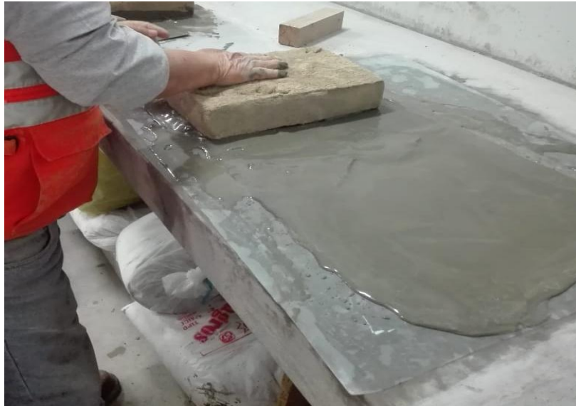
Fotografía 19. Inicio del capeado de la muestra
