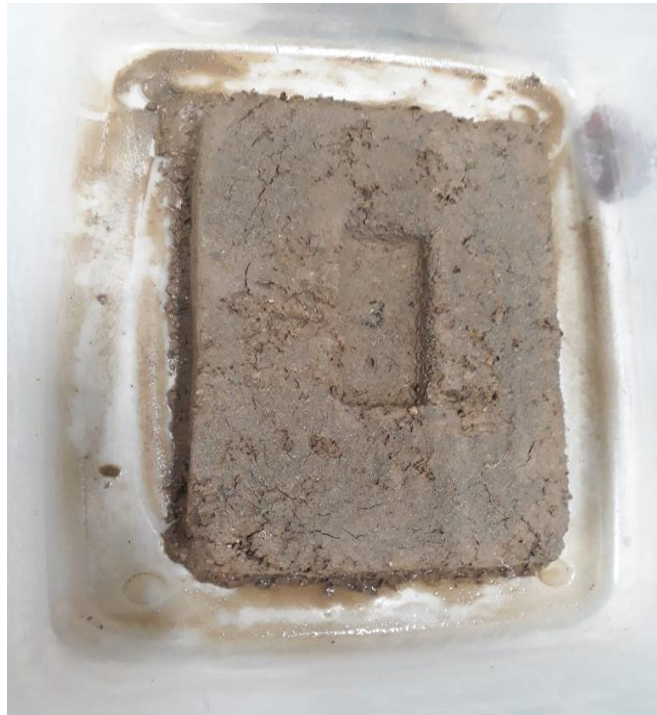
Fotografía 45. Ensayo de absorción del adobe con 3.0% de viruta
