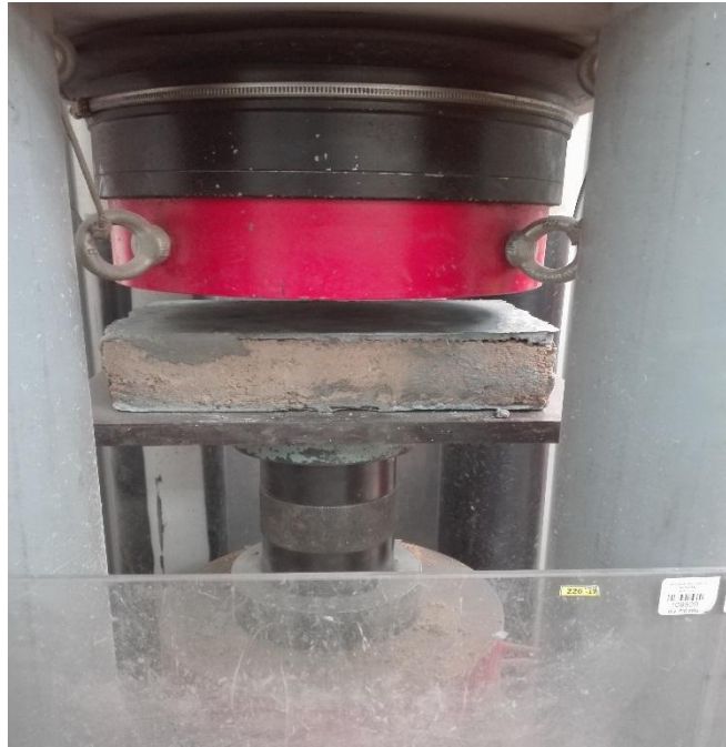
Fotografía 25, Unidad de estudio con 1.5% de viruta de eucalipto
