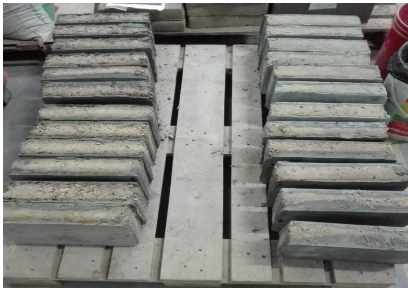
Fotografía 22. Capeado de las 48 muestras para los ensayos mecánicos
