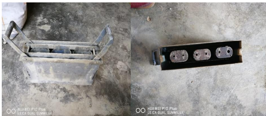
Figura 10: Moldes para el diseño de bloquetas de medida 10x20x40
