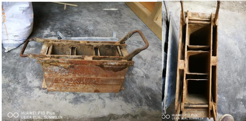
Figura 11: Moldes para el diseño de bloquetas de medida 15x20x40
