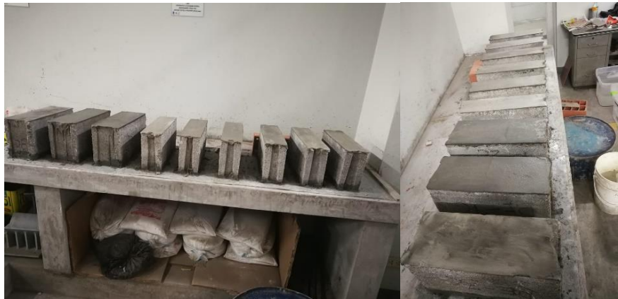
Figura 37: Capeado de las bloquetas
