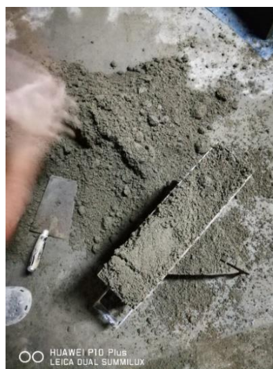
Figura 26: Proceso de moldeado de bloquetas de uso no estructural
