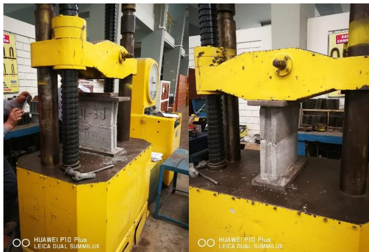
Figura 46: Ensayo de las pilas
