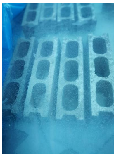
Figura 22: Proceso de curado de las bloquetas de uso estructural
