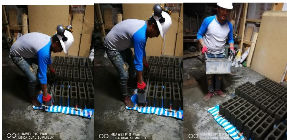
Figura 20: Proceso de producción de bloquetas de uso estructural
