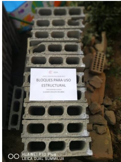
Figura 21: Proceso de selección de bloquetas para uso estructural
