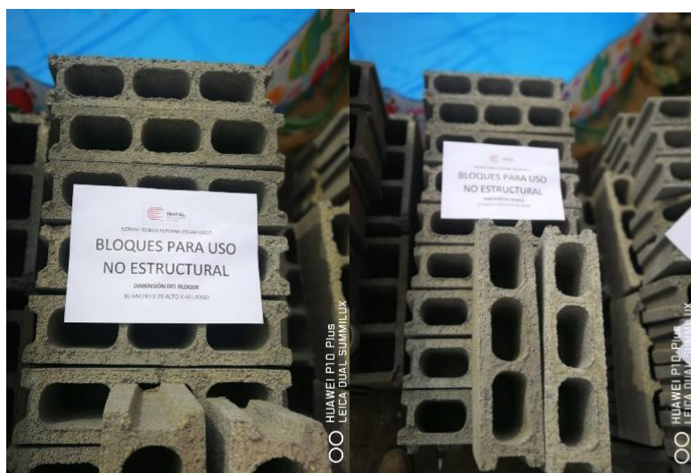
Figura 28: Proceso de selección de bloquetas de uso no estructural
