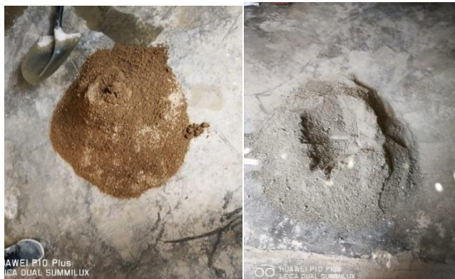
Figura 18: Proceso de mezclado para bloques de uso estructural
