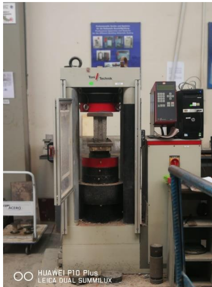
Figura 38: Ensayo de resistencia a la compresión en bloquetas
