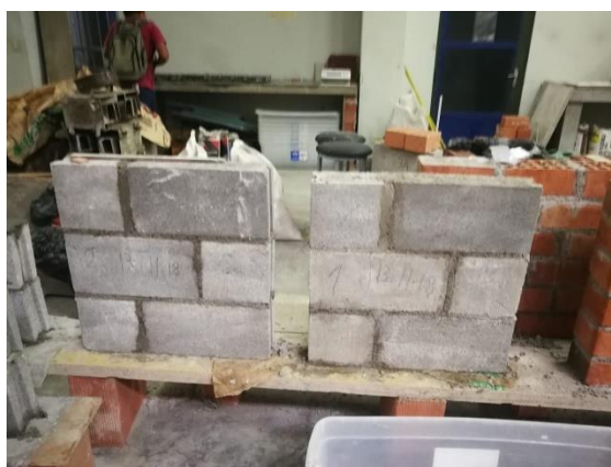
Figura 47:Elaboración de los muretes .
