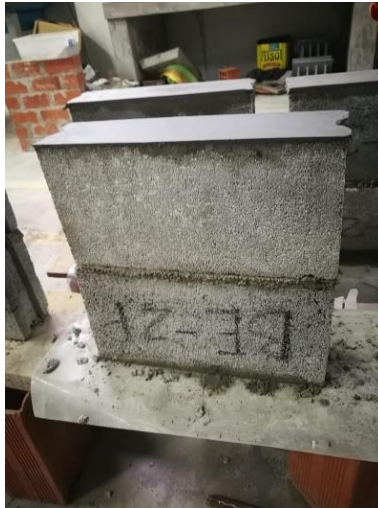
Figura 45: Capeado de las pilas
