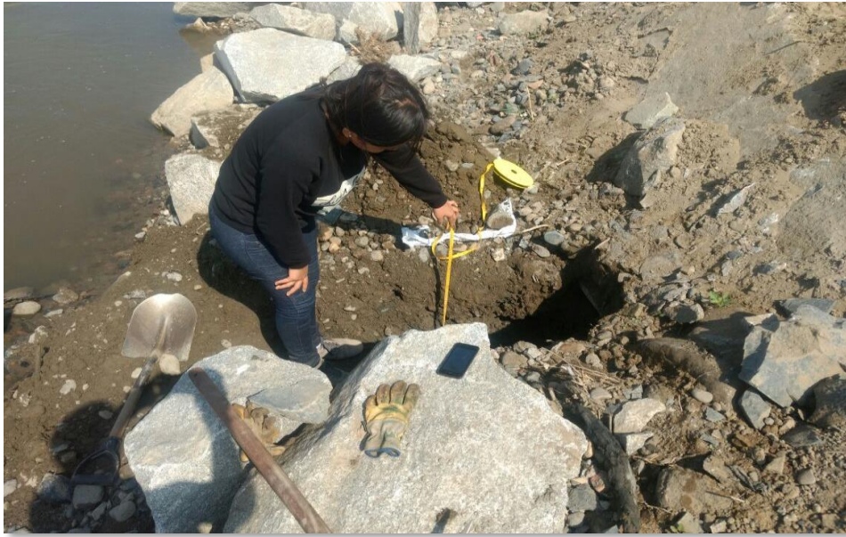
Tesista tomando la medida de profundidad alcanzada en la calicata N°1, el cual fue de 1.10m.
