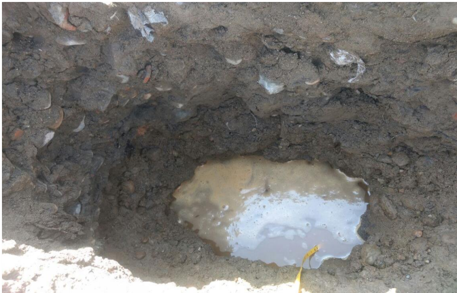
Fotografía de la profundidad alcanzada en la calicata N°2, el cual fue de 0.90m.
