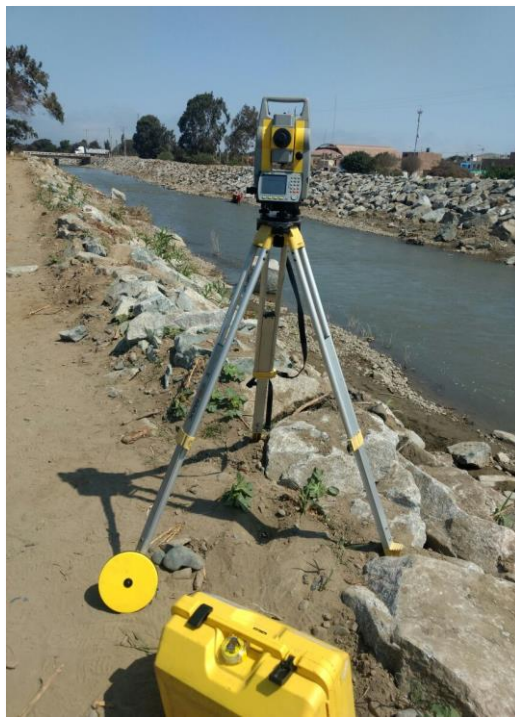
Fotografía de la Estación total, marca GEOMAX, modelo ZOOM35.
