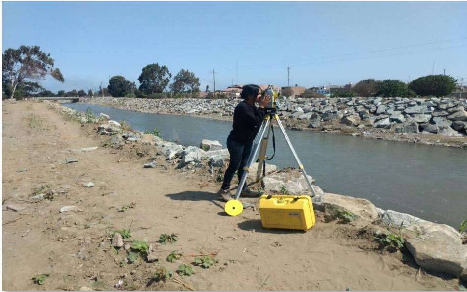
Tesista realizando el levantamiento topográfico con el apoyo de la estación total.
