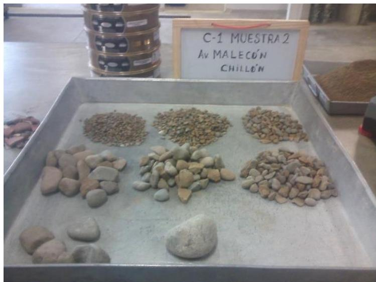
**Figura 8.** Separación en tamaños del material de la ribera. (Fuente: Imagen propia, 2018)
