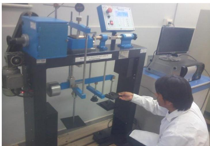
**Figura 25.** Preparación para el corte directo. (Fuente: Imagen propia, 2018)
