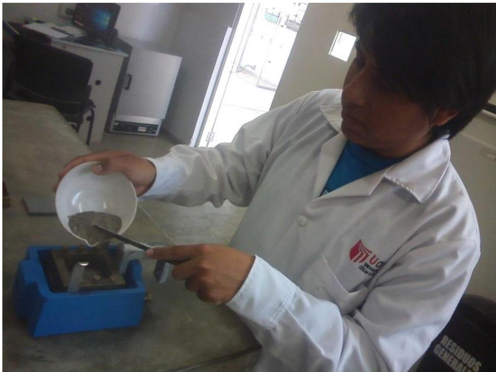
**Figura 62.** Ensayo de corte directo. (Fuente: Elaboración propia, 2018)
