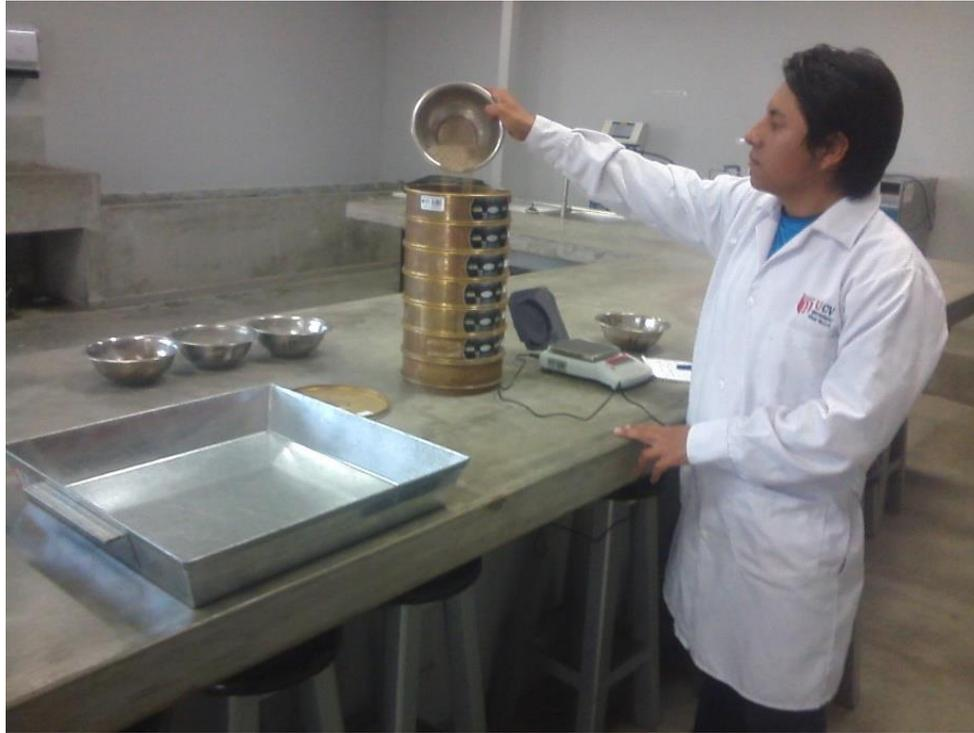
**Figura 61.** Ensayo granulométrico por tamizado. (Fuente: Elaboración propia, 2018)
