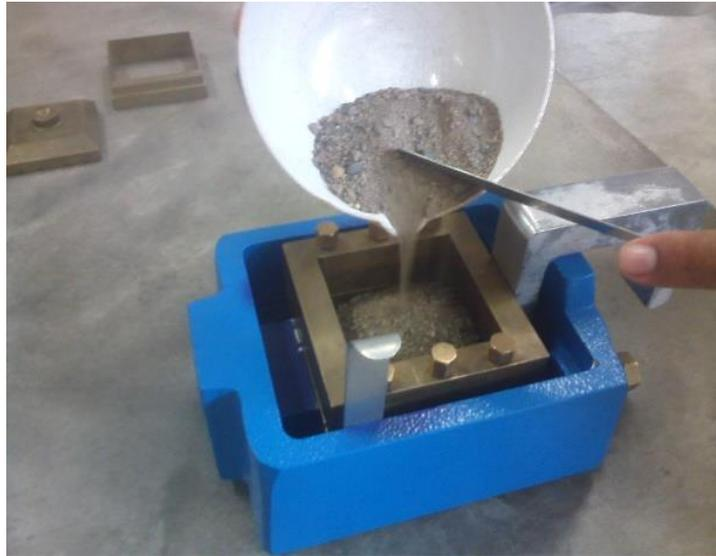
**Figura 9.** Instrumento para el corte directo. (Fuente: Imagen propia, 2018)
