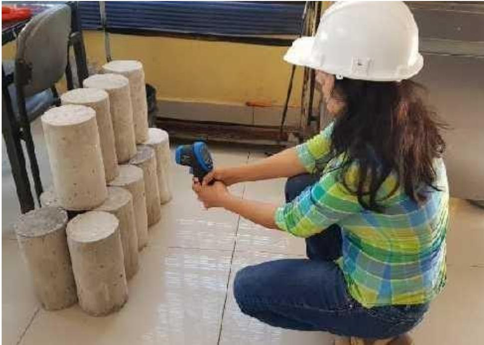
**Ilustración 15. Medición de la temperatura inicial de los testigos de concreto.**
