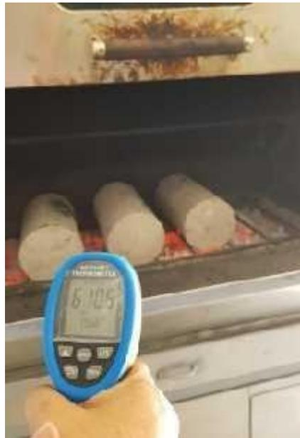
**Ilustración 20. Testigos de concreto en el horno a 750° C**
