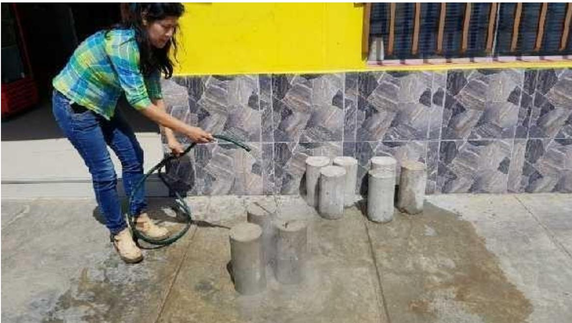
**Ilustración 22. Regulación de la temperatura de las probetas con agua**
