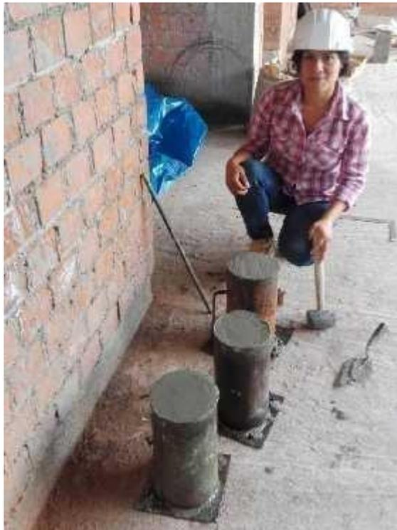
**Ilustración 12. Probetas recién elaboradas**
