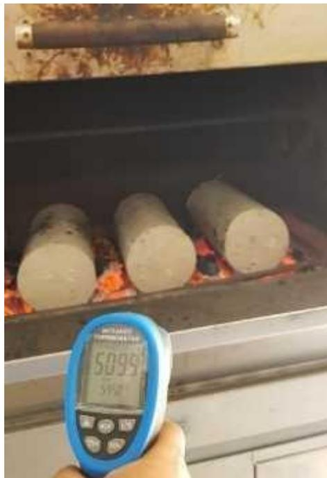
**Ilustración 18. Testigos de concreto en el horno a 550° C**
