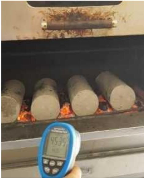
**Ilustración 17. Testigos de concreto en el horno a 450° C**
