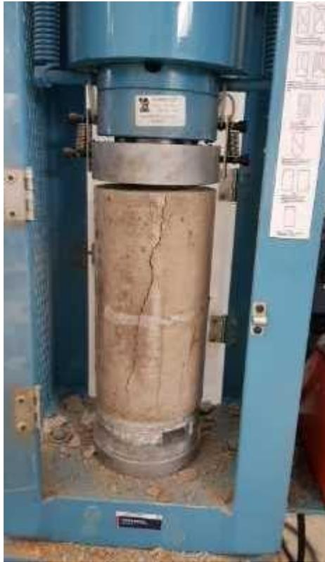
**Ilustración 27. Rotura de Probetas**
