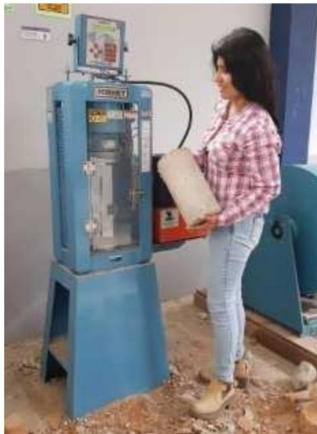
**Ilustración 26. Colocación de la probeta en el equipo para realizar el ensayo.**
