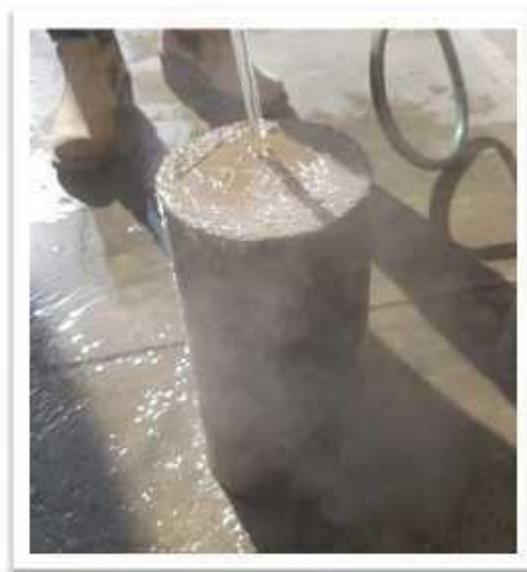
**Ilustración 1. Emisión de vapor y fisuración debido al contacto del agua con la elevada temperatura de la probeta**
