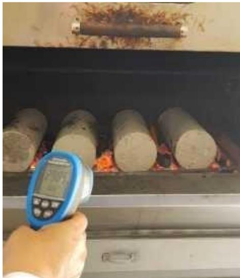
**Ilustración 16. Testigos de concreto en el horno a 350° C**
