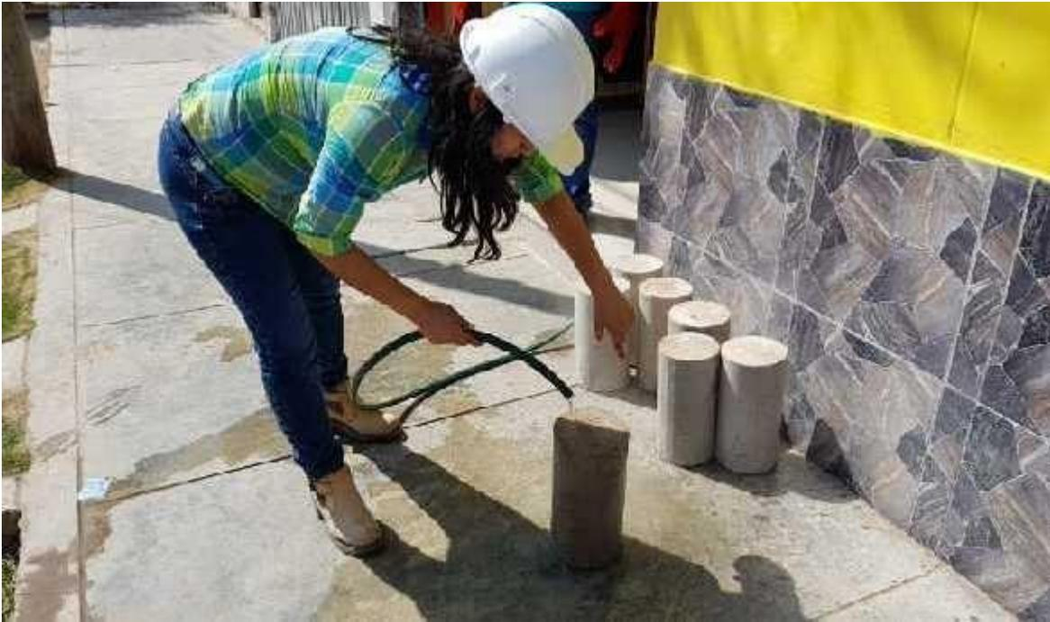
**Ilustración 23. Regulación de la temperatura de las probetas con agua**
