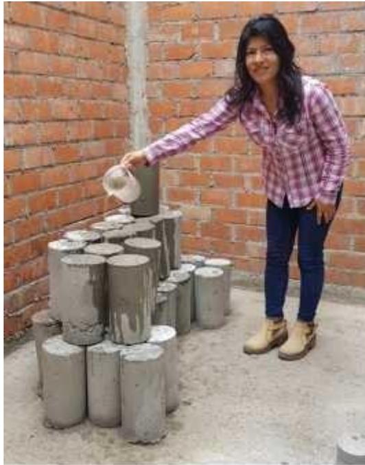
**Ilustración 13. Curado de Probetas de Concreto**
