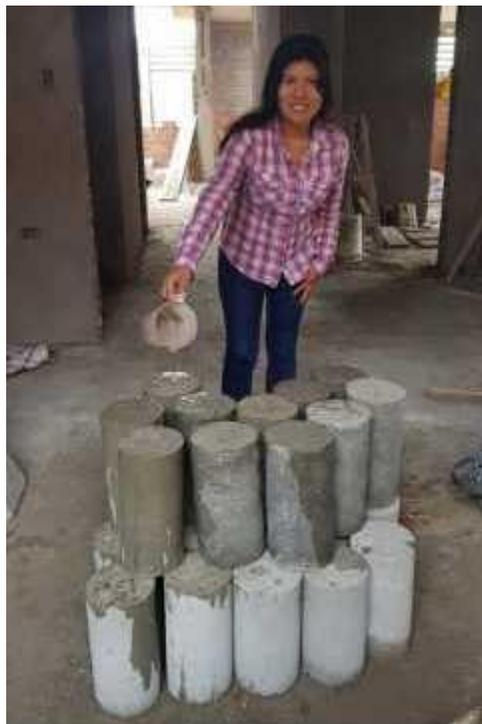
**Ilustración 14. Curado de Probetas de Concreto**
