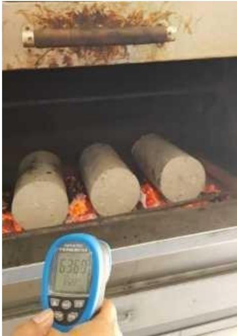
**Ilustración 19. Testigos de concreto en el horno a 650° C**
