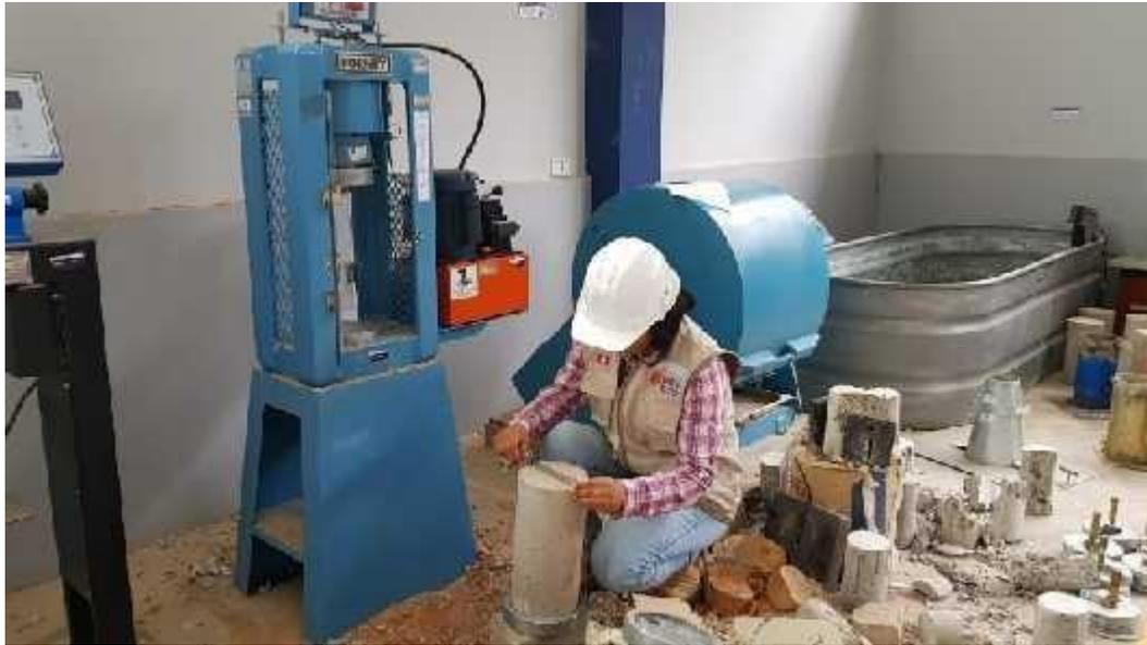
**Ilustración 25. Medición de las dimensiones de las probetas de concreto.**
