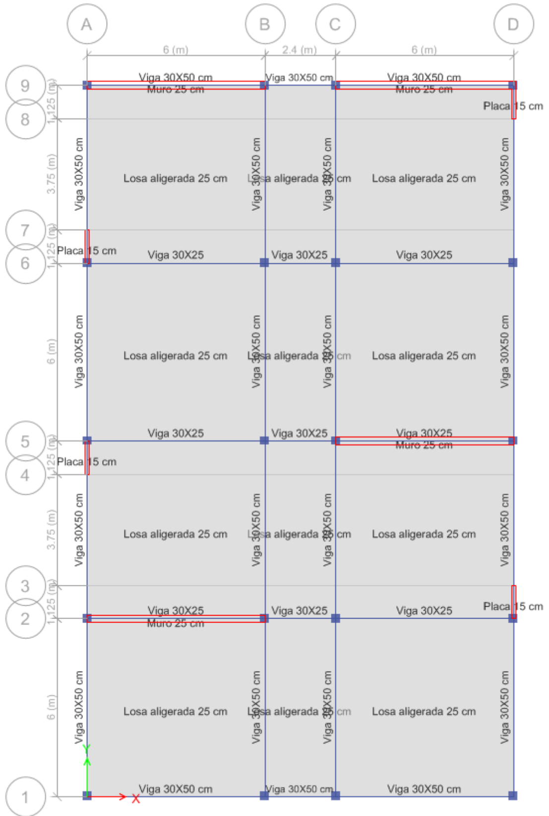
Figura 22. Elemento estructural visto en planta de viga, columna, placa y losa aligerada.
