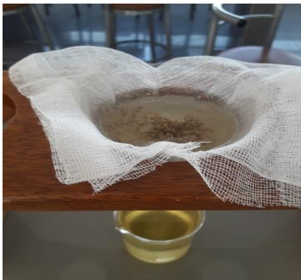
Figura 20: Filtración de aceite
