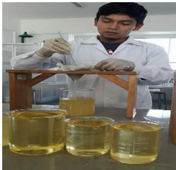
Figura 21: Filtración de aceite
