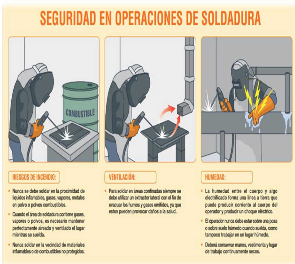
Figura 2. Seguridad en operaciones de soldadura
