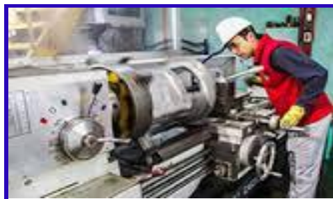
Figura N°: 18 Maquina Industrial de Torno (área de maestranza)
