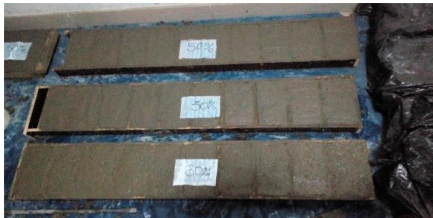
**Fotografía 28 fraguado de los adoquines**
