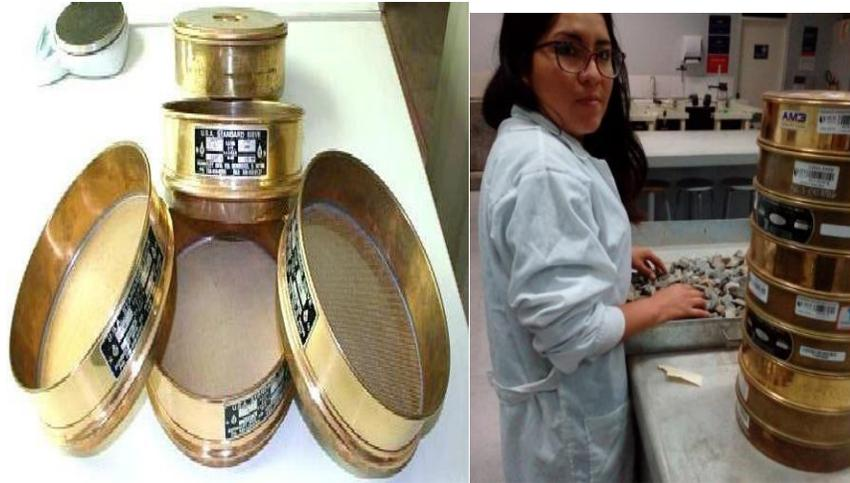
**Fotografía 15 tamizado de los agregados**
