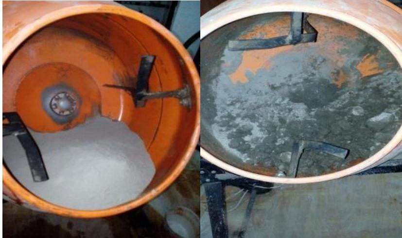
**Fotografía 23** mezclado del agregado reciclado
