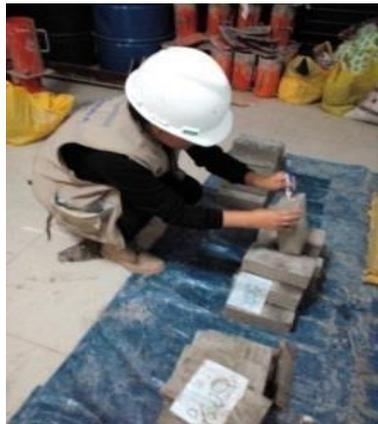
**Fotografía 31 adoquines con 0 % de agregado reciclado**
