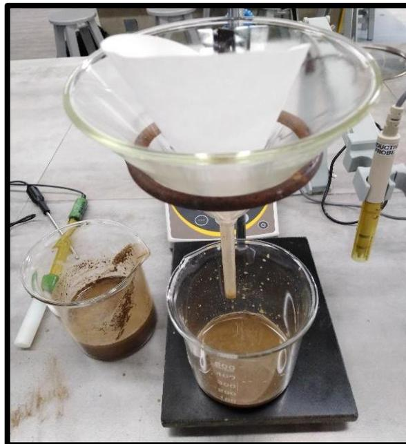
**Figura 12.**Filtración de la mezcla de agua con suelo en un vaso de precipitación.
