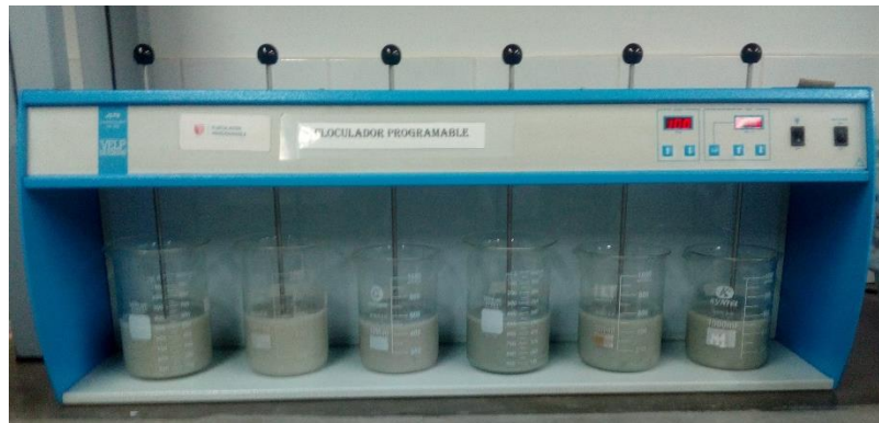
Figura 14: Prueba de jarras para determinar el tiempo óptimo
