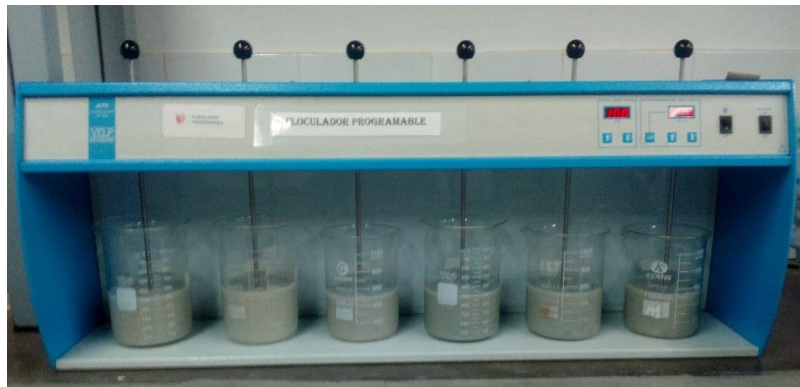
Figura 13: Prueba de jarras con dosis diferentes
