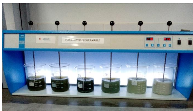
Figura 12: Prueba de jarras a pH diferentes
