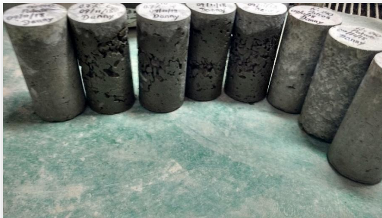
Figura N° 29: Testigos de concreto drenante a los 7 días.
