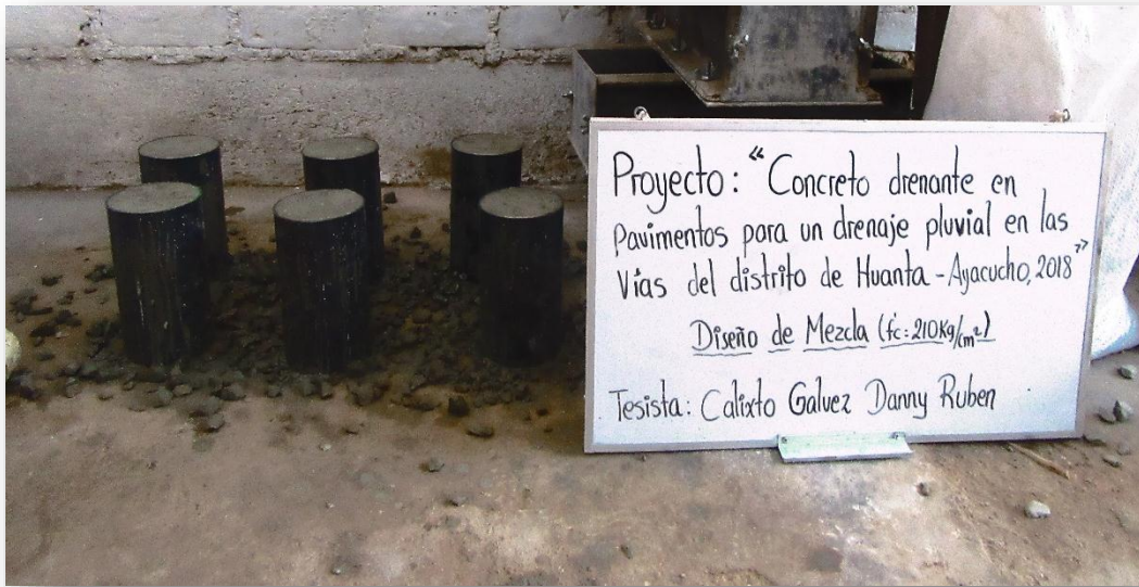
Figura N° 18: Briguetas elaboradas en primera fase.
