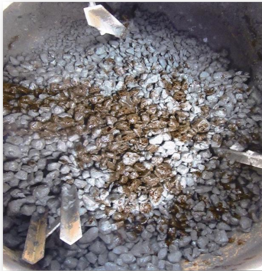
Figura N° 24: Mescla del concreto con aditivo 1.0%.
