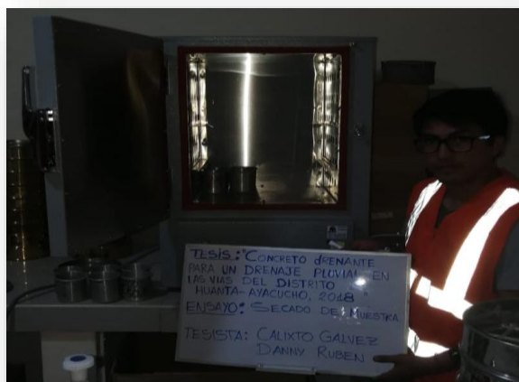
Figura N° 14. Secado de la muestra en horno.
