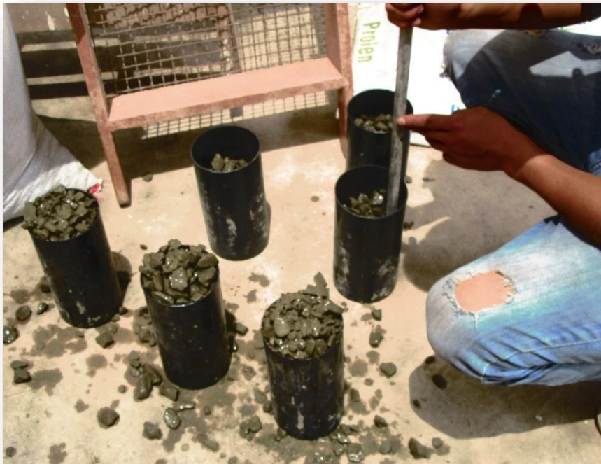
Figura N° 21: Apisonado del concreto en moldes con aditivo 0.7%.
