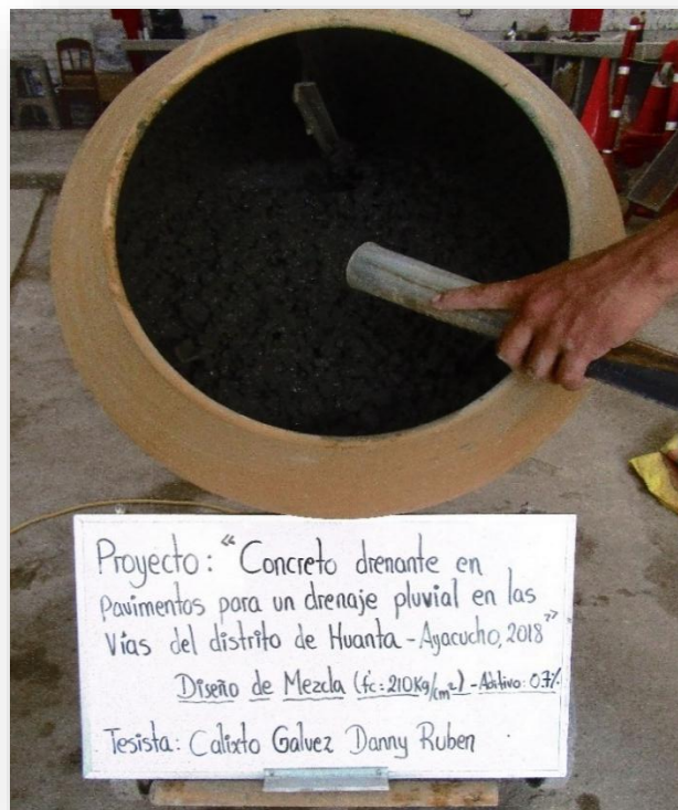
Figura N° 19: Adición del aditivo plastificante 0.7%.
