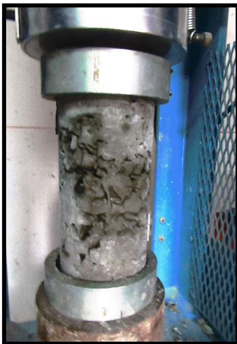
Figura N° 34: Rotura del concreto drenante día 14.
