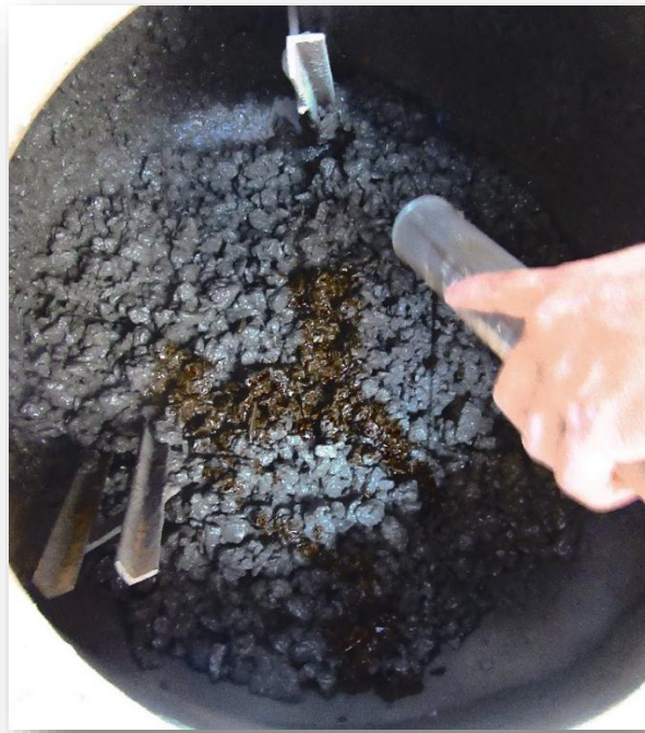
Figura N° 20: Mescla de concreto con aditivo 0.7%.
