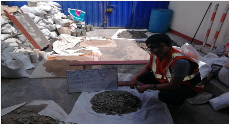
Figura N° 9. Cuarteo de muestra agregado 3/8".
