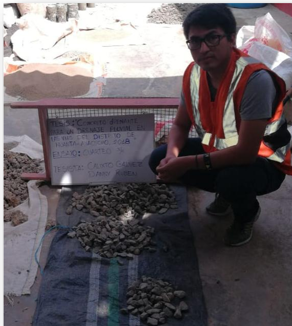
Figura N° 10. Cuarteo de muestra de agregado 3/4".
