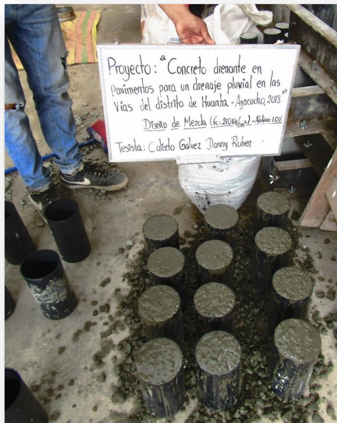
Figura N° 25: Testigos de concreto con aditivo 1.0%.
