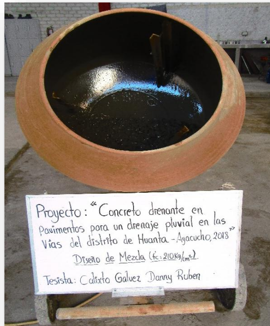
Figura N° 16. Mezcla del concreto drenante patrón.
