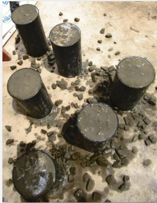
Figura N° 22: Briguetas elaboradas en segunda fase con aditivo 0.7%.
