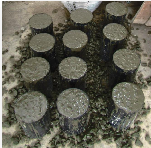
Figura N° 26. Briguetas elaboradas en tercera fase con aditivo 1.0%.
