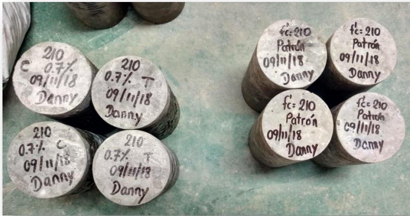
Figura N° 30: Testigos de concreto drenante Patrón, 0.7%, 1.0% y 1.4% con aditivo.
