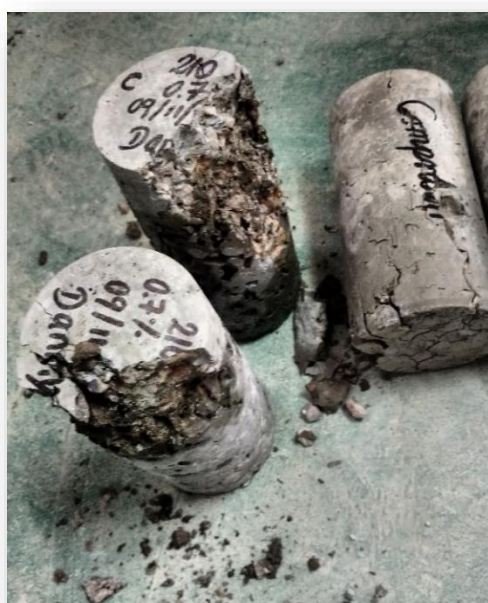
Figura N° 32: Rotura de la muestra 0.7% a los 7 días.
