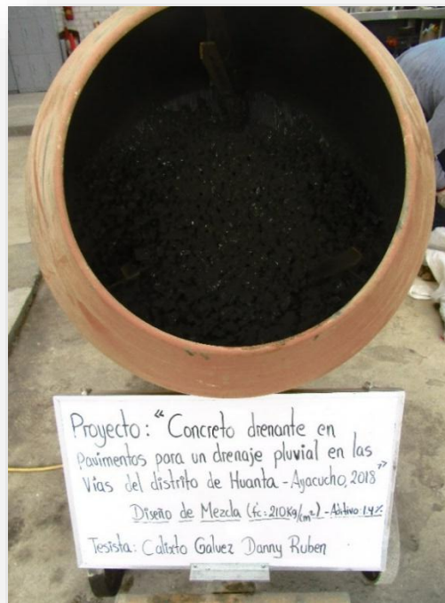
Figura N° 27. Mesclado de concreto con aditivo 1.4%.
