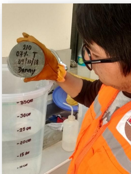
Figura N° 42: Permeabilidad de muestra con aditivo 0.7%.
