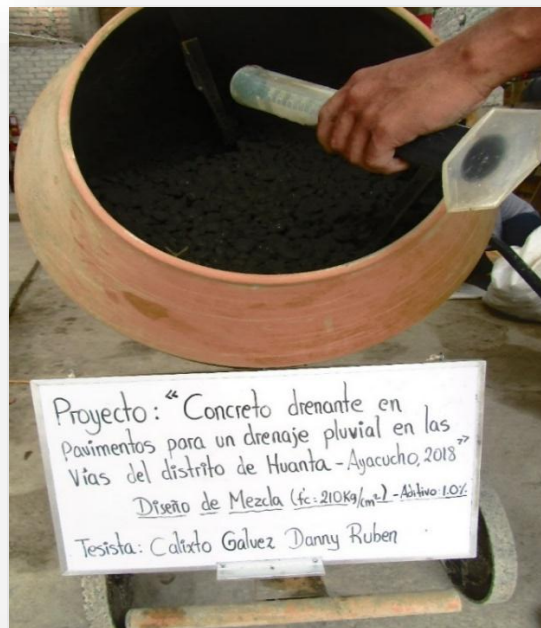
Figura N° 23: Mesclado de concreto con aditivo 1.0%.
