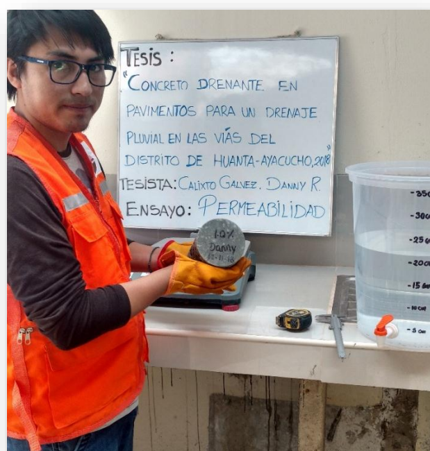
Figura N° 43: Permeabilidad de muestra con aditivo 1.0%.
