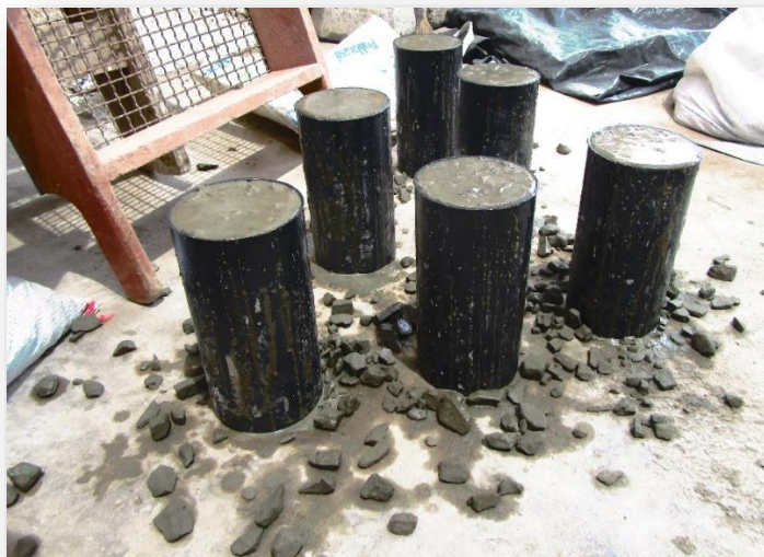
Figura N° 17: Vaciado en probetas para concreto patrón.
