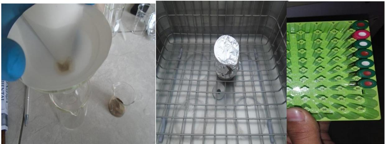
Figura. 04. Procedimiento para la extracción del plaguicida. Sólido - líquido
