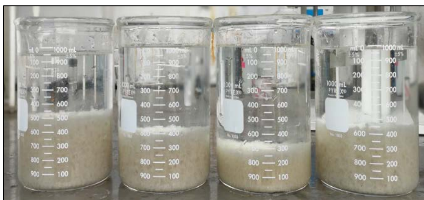
Figura 7: Proceso de sedimentación después de la coagulación.
