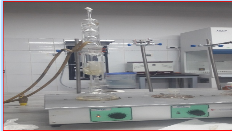
Figura 3: Extracción del aceite de polvo de Moringa Oleífera en el equipo soxhlet y (hexano).
