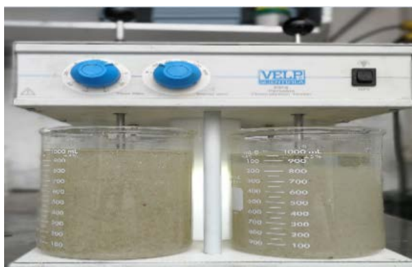
Figura 6: Proceso de coagulación en el equipo Floculador VELPF4.
