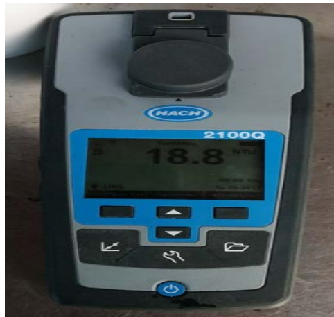
Figura 9: Determinación de la turbiedad.
