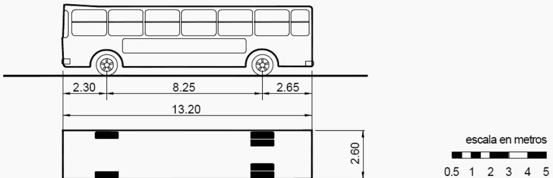
*Figura 9 Giro mínimo para ómnibus de dos ejes*
