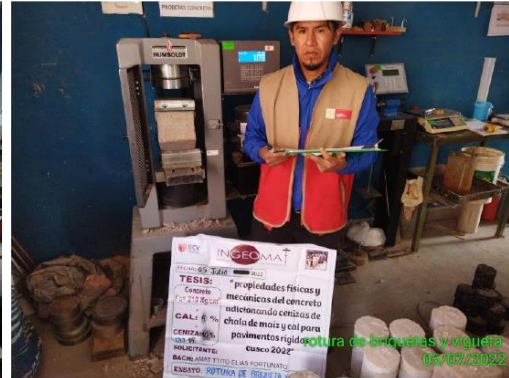
Fotografía 5 Y Fotografía 6 Compresión uniaxial de unidades de concreto con 4% de cal y 5% de ceniza de chala de maíz a los 7 días y 14 días.
