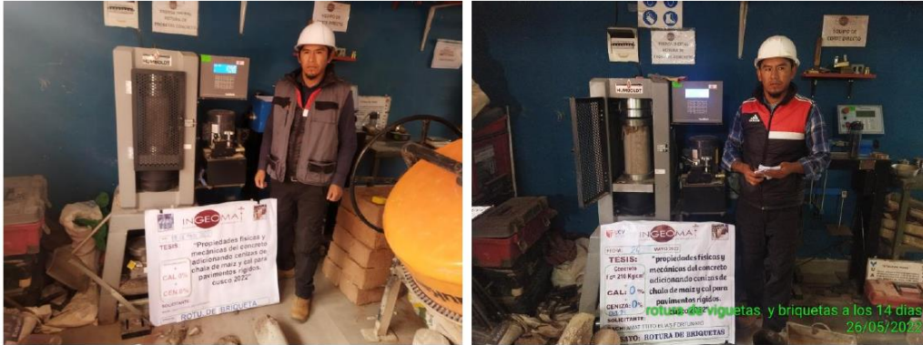
Fotografía 1 Y Fotografía 2 Compresión uniaxial de unidades del patrón de 7 días y de 14 días.
