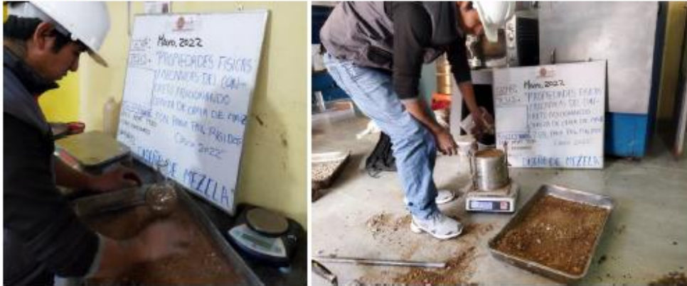
Fotografía 1 Y Fotografía 2 IZQUIERDA: Determinación del peso específico, DERECHA: Determinación del peso unitario varillado.
