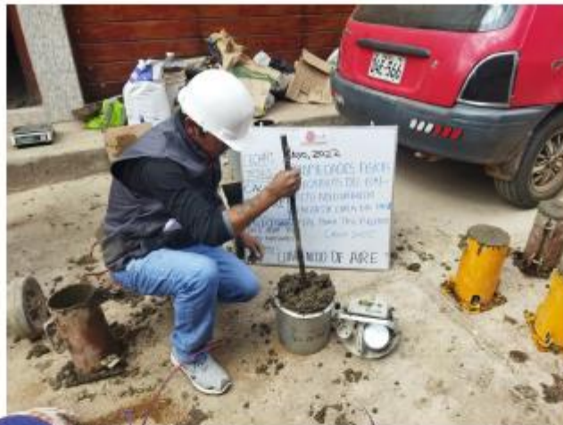
Fotografía 1 y 2 Determinación del contenido de aire del concreto.
