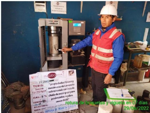
Fotografía 7 Y Fotografía 8 Compresión uniaxial de la unidad de concreto con 5% de cal y 12.5% de ceniza de chala de maíz a los 7 días y Compresión uniaxial de la unidad de concreto con 5% de cal y 5% de ceniza de chala de maíz a los 14 días.
