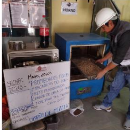
Fotografía 5 Y Fotografía 6 IZQUIERDA: Análisis granulométrico, DERECHA: Colocación de las muestras en el horno para posterior análisis granulométrico.
