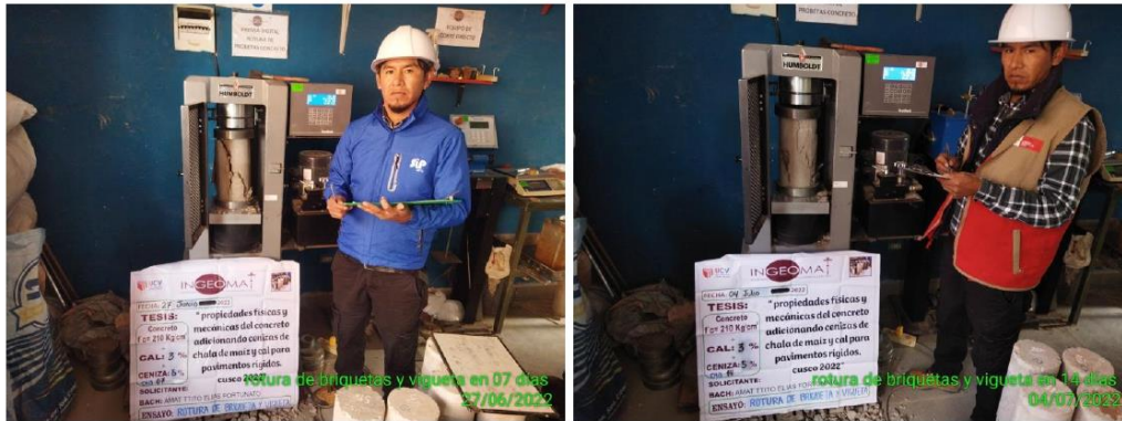
Fotografía 3 Y Fotografía 4 Compresión uniaxial de unidades de concreto con 3% de cal y 5% de ceniza de chala de maíz a los 7 días y 14 días.
