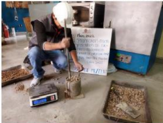
Fotografía 7 Y Fotografía 8 IZQUIERDA: Peso unitario varillado, DERECHA: Determinación del peso específico.
