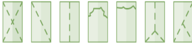
Figura 4. Tipos de fractura o falla al realizar el ensayo a la compresión
