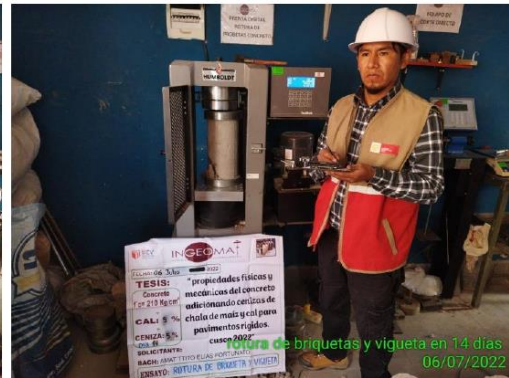
Fotografía 7 Y Fotografía 8 Compresión uniaxial de la unidad de concreto con 5% de cal y 12.5% de ceniza de chala de maíz a los 7 días y Compresión uniaxial de la unidad de concreto con 5% de cal y 5% de ceniza de chala de maíz a los 14 días.
