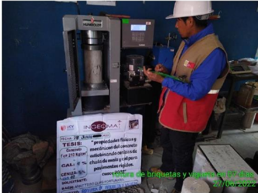
Fotografía 5 Y Fotografía 6 Compresión uniaxial de unidades de concreto con 4% de cal y 5% de ceniza de chala de maíz a los 7 días y 14 días.
