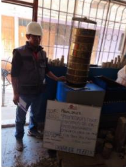
Fotografía 5 Y Fotografía 6 IZQUIERDA: Análisis granulométrico, DERECHA: Colocación de las muestras en el horno para posterior análisis granulométrico.
