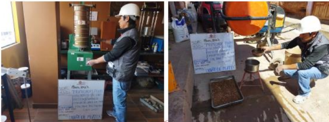
Fotografía 3 Y Fotografía 4: IZQUIERDA: Análisis granulométrico, DERECHA: Lavado de muestras para posterior análisis granulométrico.
